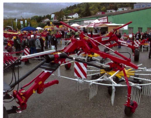
Mit 13 Kreiselarmen ist beim Seitenschwader Top 722 eine ausgezeichnete Rechenqualität garantiert.
