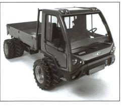
Caron wird auf der Agrama die neue gefederte Baureihe CTS ausstellen, mit hydropneumatischem Einzelradfederungssystem und Leistungen bis 120 PS. In diesem Fahrzeug regelt die elektronische Steuerung der Federungen das Schlingern bei Kurven und die automatische Nivellierung bei Änderungen der Last. Bei steilen Steigungen sind die Federungen sperrbar, und in diesem Fall wird das zentrale Gelenk im Rahmen immer Bo-
