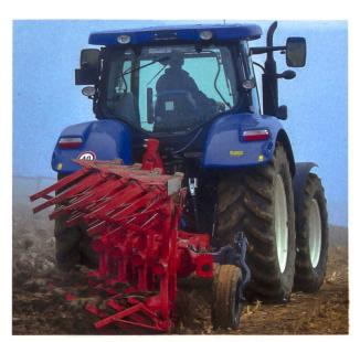
Position Stützrad: Bei einigen Pflügen sind verschiedene Anbringungsmöglichkeiten für das Pendelstützrad möglich. Eine andere Position verändert den seitlichen Überstand (Grenzpflügen). Die Position des Stützrades beeinflusst auch die Position des Oberlenkers, unter Umständen kann nicht im Langloch gefahren werden.
