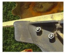
Seitengriff: Ein geringer Seitengriff in den ungepflügten Boden sichert dem Pflug eine gute Führung und sorgt für ein sauberes Pflugbild. Zu viel Seitenund Untergriff erhöhen den Zugkraftbedarf und damit den Treibstoffverbrauch.
