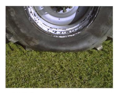
Frontgewicht: Mindestens 20% des Betriebsgewichtes müssen auf der Vorderachse sein. Genügend Frontgewicht sichert die richtige Funktion der Zugkraftregelung und verbessert die Traktion der Vorderachse.
