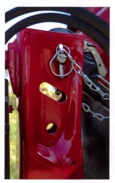
Oberlenkeranbau: Viele Pflüge sind mit einem zusätzlichen Langloch für den Oberlenker ausgerüstet. Dieses Langloch kann ab 4-Schar-Pflügen verwendet werden. Die Stützradposition wirkt sich auf die Verwendung des Langlochs aus. Bei Traktoren mit Oberlenkerregelung ergibt die Verwendung des Langlochs keinen Sinn, da dadurch die Funktion der Zugkraftregelung beeinträchtigt wird.
