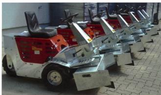
Neu zum vielfältigen Produktesortiment der Firma Dirim AG in Hauptwil gehört der Kotschieber Westermann. Ausgestattet mit einem Industriemotor von Honda sorgt er für effektives, kraftvolles und bequemes Arbeiten im Stall. Der hydrostatische Antrieb über die Frontachse und Zusatzgewichte von fünfzig Kilogramm führen zu einer optimalen Kraftübertragung. Ausgerüstet ist der Aufsitzspaltenschieber zudem mit einem robusten, verzinkten Rahmen und einem am
