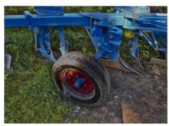
Arbeitstiefe: Die Arbeitstiefe wird mit der Zugkraftregelung vorgewählt, aber mit dem Oberlenker und dem Tastrad eingestellt. Dabei gilt üblicherweise der Grundsatz: «So flach wie möglich, so tief wie nötig». Die Einstellung des Pendelstützrades muss für beide Seiten gleich gewählt werden.
