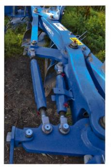
Schnittbreiteneinstellung: Am «Einstellzentrum» wird sowohl die Schnittbreite des ersten Pflugkörpers als auch der Zugpunkt eingestellt. Die Schnittbreite des ersten Pflugkörpers muss jener der anderen Pflugkörper entsprechen. Pflugneigung und Arbeitsbreite des ersten Körpers stehen in engem Zusammenhang.
