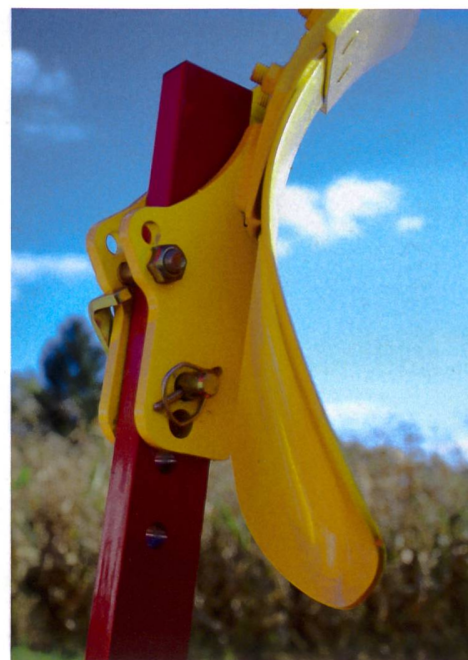
Vorschälereinstellung: Die richtige Einstellung der Vorschäler beeinflusst die Arbeitsqualität und das Arbeitsbild des Pfluges. Während die Einstellung der Klemmschrauben bei älteren Pflügen mit Doppelmeter und Schraubenschlüssel erfolgt, bieten Pflugerhersteller heute Schnellverstelllösungen an.
