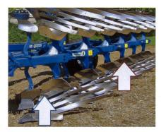
Zusatzausrüstung: Strohleitbleche sind gleichmässig und nicht zu steil einzustellen, so kann das Material zügig abfliessen und wird nicht zu tief vergraben. Auch Vorschälerverlängerungen sind zu kontrollieren und, wenn nötig, überall in die gleiche Position zu bringen.
