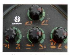
Vorwahl Lage-/Zugkraftregelung: Für die eigentliche Pflugarbeit ist die Zugkraftregelung zu wählen (Betriebsanleitung Traktor!), damit wird Gewicht vom Pflug auf die Hinterachse übertragen. Für Strassenfahrten ergibt es aus Sicherheitsgründen Sinn, die Lageregelung zu verwenden.
