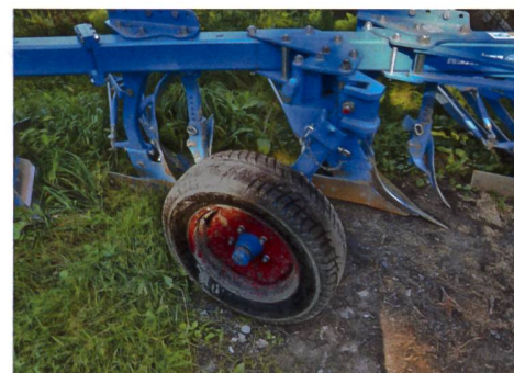
Arbeitstiefe: Die Arbeitstiefe wird mit der Zugkraftregelung vorgewählt, aber mit dem Oberlenker und dem Tastrad eingestellt. Dabei gilt üblicherweise der Grundsatz: «So flach wie möglich, so tief wie nötig». Die Einstellung des Pendelstützrads muss für beide Seiten gleich gewählt werden.
