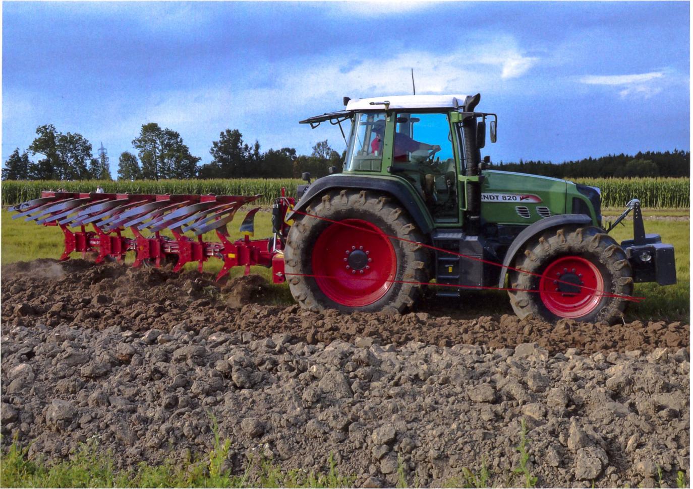
Ober-/Unterlenkerstellung: Die «gedachten Verlängerungslinien» von Oberlenker und Unterlenker sollen sich in Arbeitsstellung bei der Vorderachse kreuzen (Praxisaussagen und Literatur «sprechen» von unmittelbar vor bis unmittelbar hinter der Achse!). Damit wird sichergestellt, dass die Frontachse auch die notwendige Traktion aufweist.
