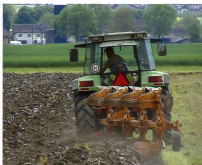
Neigungseinstellung: Die Neigung des Pfluges zur Bodenoberfläche wird, mit etwas Distanz, in Fahrrichtung von hinten kontrolliert. Korrekturen sind mithilfe der Anschlagschrauben oder Anschlagspindeln, bei neuen Pflügen mittels Drehwinkelsensor, möglich.
