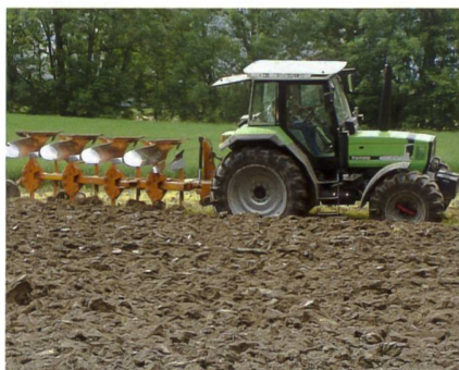
Stellung Pflugbaum: Der Pflug ist so einzustellen, dass der Pflugbaum parallel zur Bodenoberfläche verläuft. Durch Verdrehen des Oberlenkers wird eine gleichmässige Arbeitstiefe vom ersten bis zum letzten Pflugkörper eingestellt.
