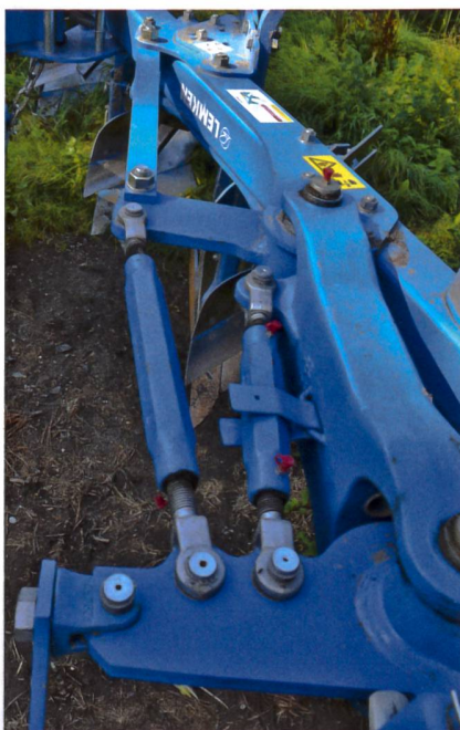
Schnittbreiteneinstellung: Am «Einstellzentrum» wird sowohl die Schnittbreite des ersten Pflugkörpers als auch der Zugpunkt eingestellt. Die Schnittbreite des ersten Pflugkörpers muss jener der anderen Pflugkörper entsprechen. Pflugneigung und Arbeitsbreite des ersten Körpers stehen in engem Zusammenhang.
