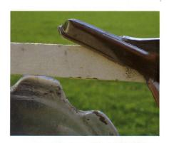
Untergriff: Die Scharspitze soll zwei bis vier Zentimeter unter die Unterkante der Anlage greifen. Dieser Untergriff sichert einen raschen Einzug und eine gleichmässige Arbeitstiefe. Mit zunehmendem Verschleiss nimmt der Untergriff ab.
