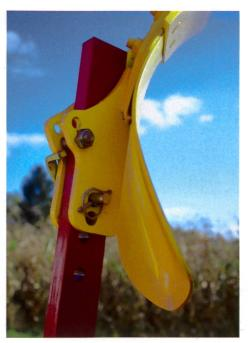
Vorschälereinstellung: Die richtige Einstellung der Vorschäler beeinflusst die Arbeitsqualität und das Arbeitsbild des Pfluges. Während die Einstellung der Klemmschrauben bei älteren Pflügen mit Doppelmeter und Schraubenschlüssel erfolgt, bieten Pflughersteller heute Schnellverstelllösungen an.
