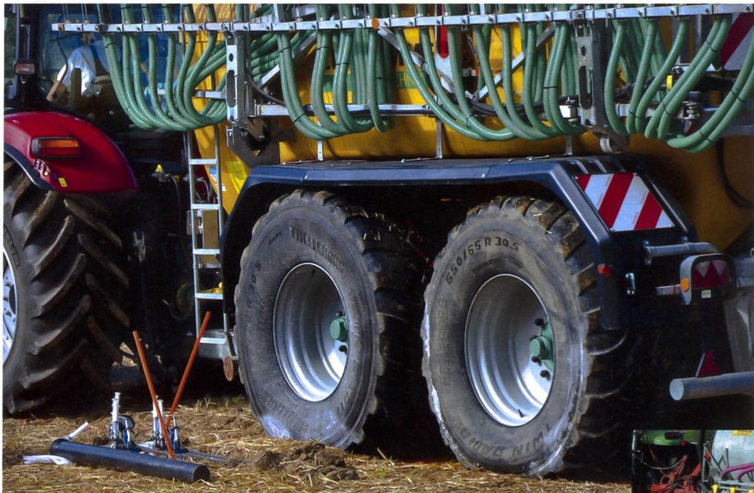
Entsprechend der Kontaktfläche zeigte die Bodendruckmessung, dass grossdimensionierte Bereifung und tiefer Reifendruck für den Oberboden erträgliche Druckwerte abgeben.
