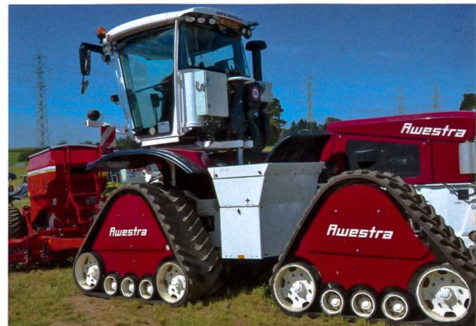
Tiefstwerte in Sachen Bodendruck erreichte das 4-fach-Raupenfahrwerk. Dabei fällt auf, dass die Belastung in unterschiedlichen Tiefen gleichmässiger ist als bei Reifen.
