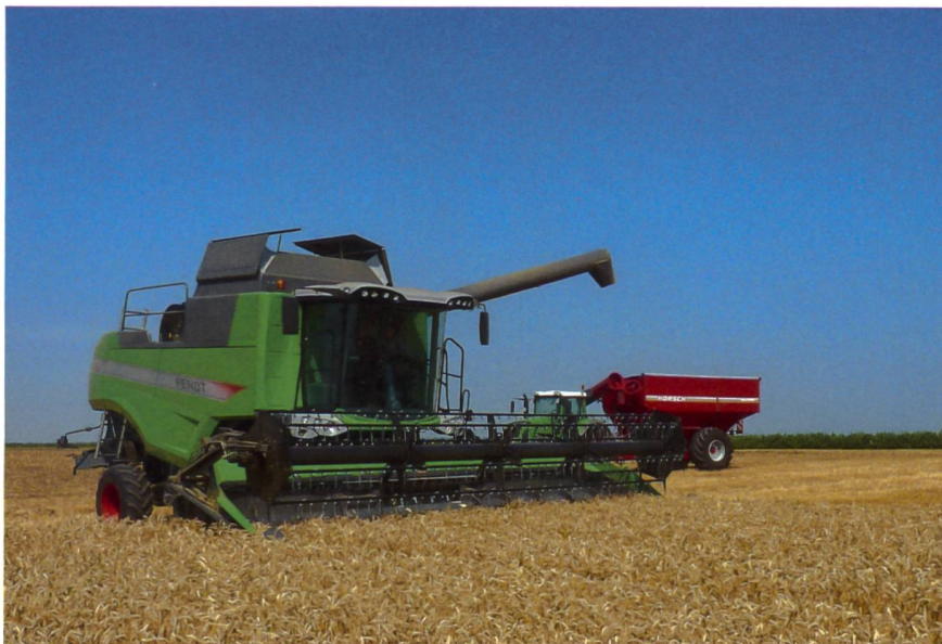
Der Mähdrescher von Fendt der Serie C hat im Zuge der Motorenumrüstung auf die selektive katalytische Reduktion (SCR) analog zu den Vario-Traktoren ein neues Design erhalten. Die Mähdrescher 5275 C und der 6335 C sind als klassische Modelle oder in der ParaLevel-Version erhältlich; das patentierte System gleicht Hanglagen bis 20% Neigung aus.
