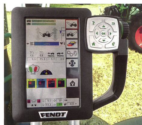
Mit dem neuen Varioterminal halten Variotronic, VarioGuide-Spurführung, Kamerafunktion sowie das Dokumentationssystem VarioDoc und die Isobus-Gerätesteuerung Einzug in diese Leistungsklasse.
