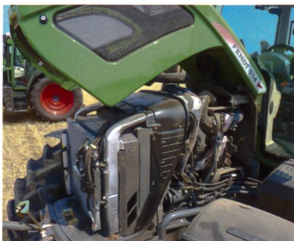
Die 500 Vario sind mit Vierzylinder-Deutz-Motoren ausgerüstet und genügen den Abgasnormen durch die selektive katalytischen Reduktion (SCR) unter Zudosierung der Harnstofflösung AdBlue.
