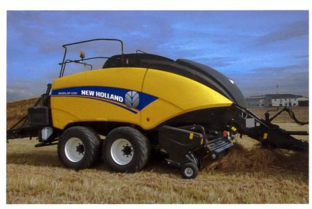
Das schnittige Design täuscht: Die Seitenverkleidungen sind einteilig, und die Wartungsfläche auf der Maschinenoberseite ist eben. (Bilder: Dominik Senn)
