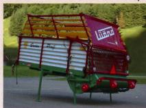
Der Lüönd-Hecklader feiert dieses Jahr das 40-Jahr-Jubiläum. Mit dem neuen Hecklader mit Dosier-Pick-up wird besonders das Abladen im Fahrsilo und Dosiergerät erleichtert. Zum Abladen übergibt der Pick-up beide Schutzgitter an das Hecktor. Beim hydraulischen Öffnen des Hecktores nimmt dieses die Schutzgitter einfach mit. Der Pick-up schwenkt gleichzeitig nach hinten und das Förderaggre-
