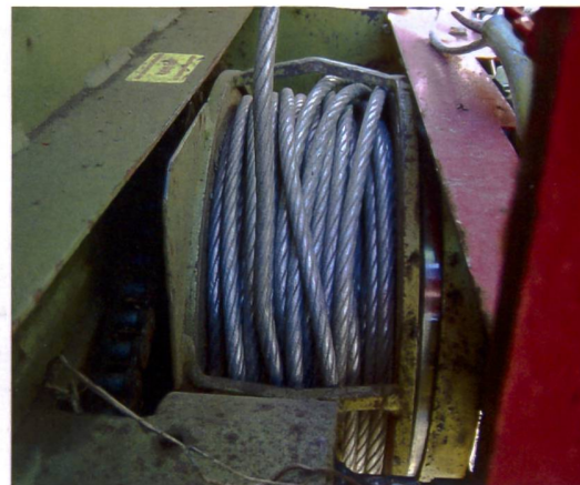
Unsorgfältig aufgewickelt: Seildefekte sind vorprogrammiert
