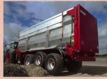
Rollbandwagen-System «Bandit» feierte seine Premiere bereits an der Agritechnica 2009. Um bequem zu be- und entladen, ist der «Bandit» statt mit einem Schiebeschild mit einem in zwei Richtungen beweglichen Gummiboden ausgestattet. Krampe hat nun mit dem «Bandit 800» ein Fahrzeug mit Aluminiumaufbau und geringem Eigengewicht entwickelt. Zusätzlich können die Tandem- und Tridemanhänger mit einer elektronisch-hydraulischen Zwangslenkung ausgerüstet werden.
