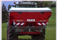
Der AXIS H EMC ist revolutionär in der Düngetechnik: Der hydraulische Scheibenantrieb mit Drehzahlregulierung zusammen mit der fernbedienten koaxialen Aufgabepunktverstellung erlaubt ein Keilstreuen, Grenzstreuen und Randstreuen; dies vom Fahrersitz aus. Die elektronische Massenstromregelung EMC
