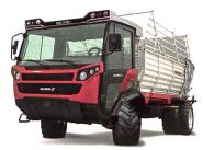
109 PS, 5050 kg Nutzlast bei einem Gesamtgewicht von 8000 kg und erhöhte Achslasten. Das sind die Eckdaten des Neuen «Muli T10 X» von Reform. Das Neigen der Kippkabine erfolgt werkzeuglos und gewährt einfachen Zugang zum Motor- und Getrieberaum. Durch den in-
