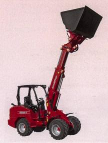
Der neue Teleradlader 3550T von Schäffer liefert mit 3,7 t Einsatzgewicht eine Kombination aus Kraft, Hubhöhe, Reich-
