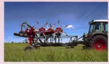
Fella stellt seinen neuen Heuwender TH 11008 Trans mit Transportfahrwerk vor: den «kleinen Bruder» des TH 13010 Trans. Der TH 11008 Trans verfügt über 8 Kreisel. Die Maschine ist mit einem Schnellfahrwerk ausgestattet. Die Hauptachse liegt im Schwerpunkt der Maschine. Die Transporträder dienen in Arbeitsstellung als Tasträder. Die Bewegungsfreiheit der einzelnen Maschinenteile ermöglicht ein besseres Abtasten und eine gute Bodenanpassung, auch quer zur Fahrtrichtung. Verschiedene
