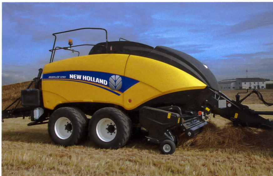
Das schnittige Design täuscht: Die Seitenverkleidungen sind einteilig, und die Wartungsfläche auf der Maschinenseite ist eben. (Bilder: Dominik Senn)
