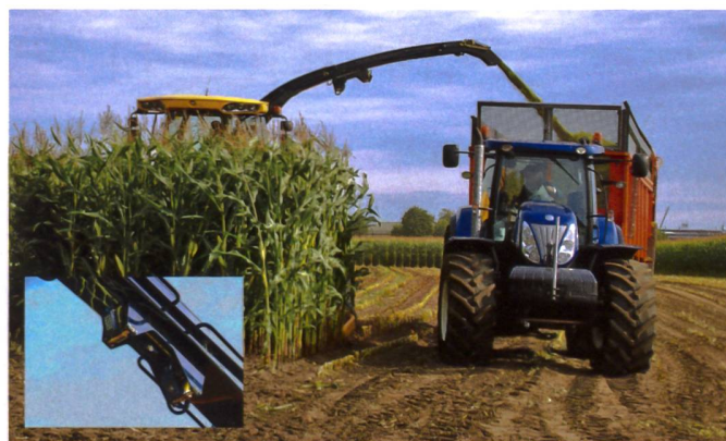
Das IntelliFill-System ermöglicht selbst bei eingeschränkter Sicht eine genaue Füllung des Anhängers mithilfe einer 3-D-Spezialkamera. Die Spezialkamera ist unter der Auswurfklappe (kl. Bild).
