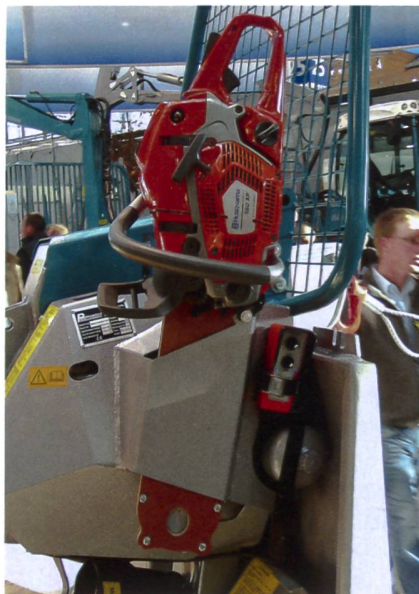
Haltevorrichtungen für Motorsäge und weitere Werkzeuge schaffen Ordnung und sind als Option für einige Winden erhältlich.
