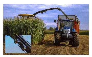
Das IntelliFill-System ermöglicht selbst bei eingeschränkter Sicht eine genaue Füllung des Anhängers mithilfe einer 3-D-Spezialkamera. Die Spezialkamera ist unter der Auswurfklappe (kl. Bild).
