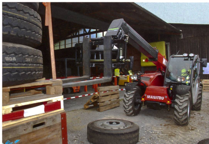
Im praktischen Teil wird mit dem Teleskopplader das zentimetergenaue Platzieren der Staplergabel geübt.
