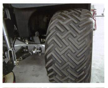
Terrareifen reduzieren die Bodenschädigung, dafür ist der Reifenverschleiss auf fester Fahrbahn oder Strassen sehr gross.
