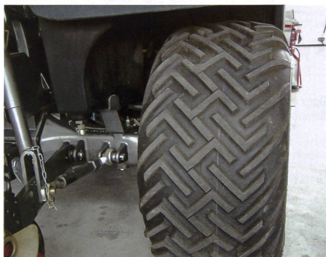
Terrareifen reduzieren die Bodenschädigung, dafür ist der Reifenverschleiss auf fester Fahrbahn oder Strassen sehr gross.
