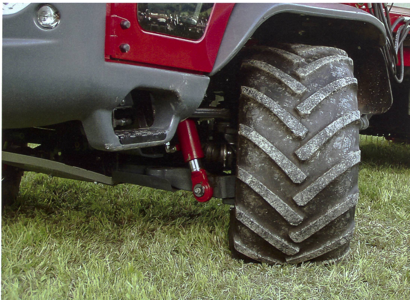
Radialreifen übertragen eine hohe Zugkraft und weisen eine hohe Querstabilität auf, verursachen aber hohe Grasnarbenschäden.
