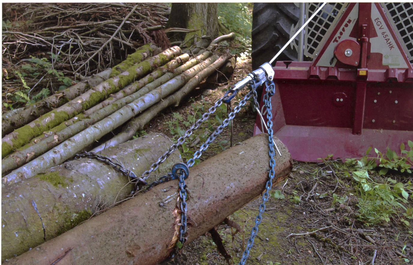
Kunststoffseile brauchen die richtige Endverbindung. (Bilder: Ruedi Burgherr)
