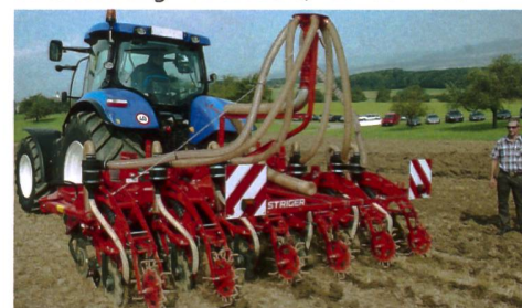
Beim Striger für die Streifenbearbeitung wird mindestens mit 10 km/h gefahren.
