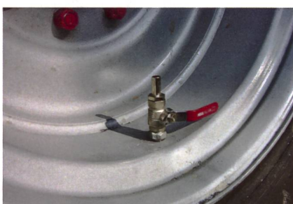
Bei der Montage wird ein Loch in die Felge gebohrt und anschliessend ein Kugelhahn montiert. (Fotos: Strotmann)
