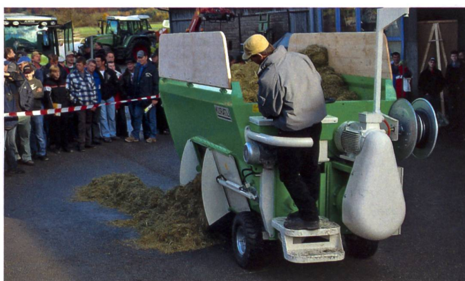
Für Klein- und Mittelbetriebe baut der Schweizer Hersteller Kuratli-Maschinenbau Mischwagen mit leisen und umweltfreundlichen Elektromotoren.
