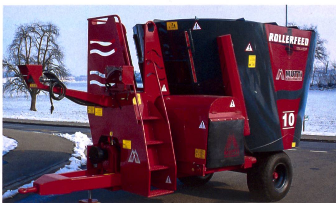
Vertikalmischer mit 10-m 3 -Mischbehälter eignen sich für Betriebe mit 40 bis 50 Kühen (nutzbaren Behälterinhalt beachten). (Foto: Martin Rickli)
