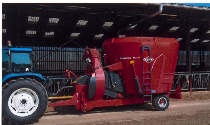
Vermeehrt soll ein FMW auch Zusatzfunktionen wie das Einstreuen mit unterschiedlichen Streumaterialien erfüllen (Bild: Zusatzgebläse). (Werkfoto)
