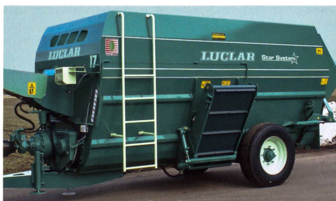
Gezogener 17-m 3 -FMW mit horizontaler Mischschnecke und einer Lademulde zur Befüllung am Heck. (Foto: Martin Rickli)
