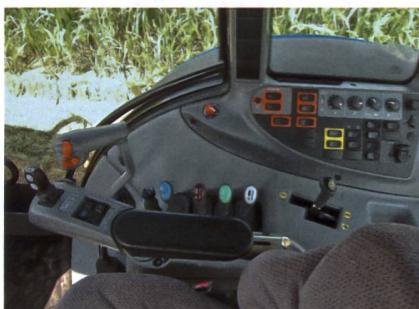
Mit dem HiTech5-Getriebe ist kein herkömmlicher Schalthebel mehr vorhanden.
