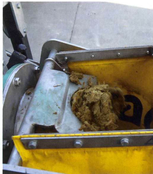
Am Ausgang des Separierungsaggregates wird mittels Gegengewichten die Auspressung reguliert.
