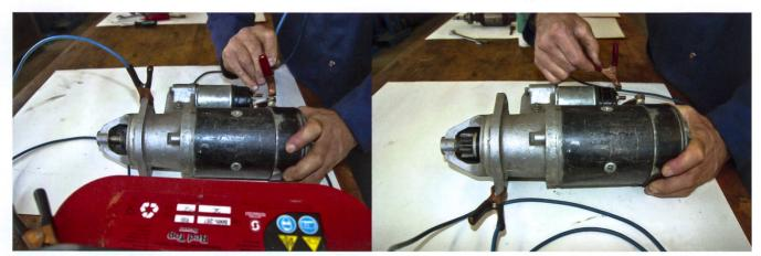
Der Anlasser muss sofort mit hoher Drehzahl laufen, wenn der Stromeingang am Anlassermotor mit dem Pluspol der Batterie verbunden wird.
