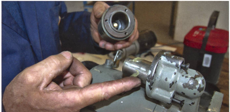
Wenn sich der Anker im Anlasserrelais nicht mehr bewegt, kann man ihn durch Reinigen und Einfetten wieder gängig machen.
