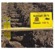
Eindrückliche Erfahrung: Mehr Schlupf bedeutet mehr Dieselverbrauch und insbesondere auch tiefere Reifenspuren.
