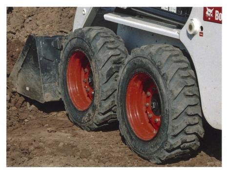
Mit den beiden neuen Reifen BibSteel All-Terrain und Hard bietet Michelin Radialreifentechnologie für Kompaktlader (mit Panzer- oder Knicklenkung) sowie Bagger- und Teleskoplader an. Diese Reifen sind auf die unterschiedlichen Anforderungen von Strassen und Off-Road-Einsatz ausgelegt. Zusätzlich verstärkte Reifenflanken tragen zur Standsicherheit der Fahrzeuge bei.
