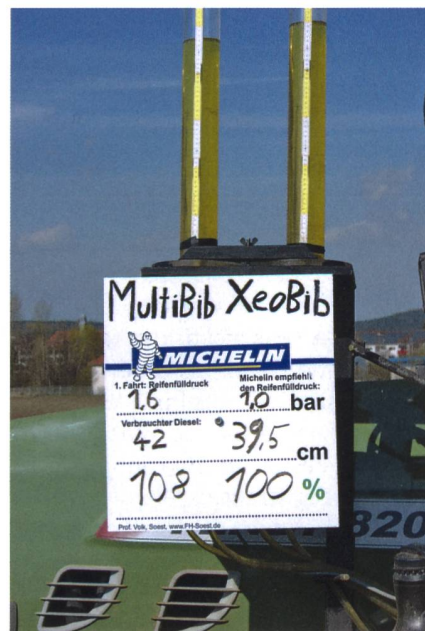
.... XeoBib übertrumpft dabei den MultiBib. Für den problemlosen Radwechsel verwenden die Studenten übrigens einen Twin-Carrier von Schaad, Subingen.
