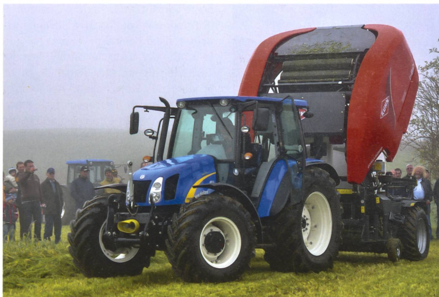
Auf dem Schweizer Markt sehr erfolgreich: Traktoren der New Holland Serie T5. Im Einsatz mit einer KUHN-i-BIO. Die Maschine produziert Rundballen mit einem festen Durchmesser von 125 cm. Ein hohes Leistungspotenzial wird durch den mit zwei Förderschnecken bestückten Rotoreinzug, die hydraulische Schneidbodenabsenkung und das integrierte Wickelsystem erzielt.
