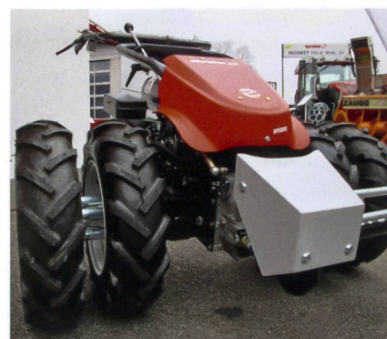
Der Einachsmäher Bergfex Zero Turn: Wendemanöver an Ort dank gegenläufig drehender Räder.
