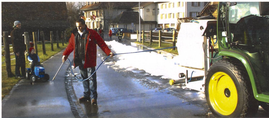
... gleich anschliessendes Auftauen von Eisflächen mittels aufgespritzter Sole; der «IceFighter» von Eco Technologies ermöglicht eine Einsparung von gegen 75 Prozent Streusalz gegenüber der herkömmlichen Methode.
