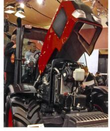
Neuer Kubota M 135 GX: Bei diesem Traktor handelt es sich noch um einen Prototyp. Er soll Ende 2012 in Serie gehen. Die Motorleistung (97/68EG) beträgt etwa 100 kW/136 PS mit SCR-Technik. Der Traktor bietet ein 8-stufiges Lastschaltgetriebe mit Automatikfunktionen an.
