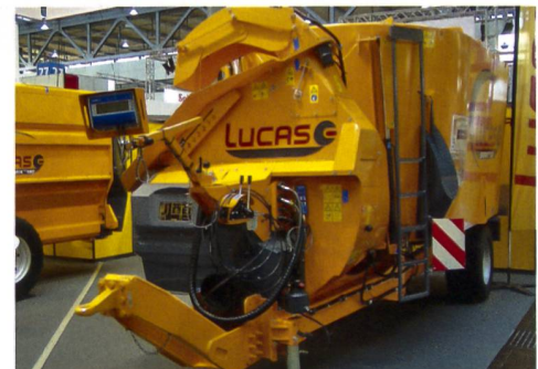
Heute mischt auch Lucas vertikal, der Austrag erfolgt aber nach wie vor über ein Turbinenrad.
