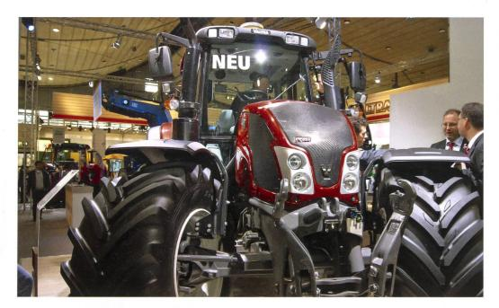
Der neue Valtra N163 mit SCR-Technik und Dieselpartikelfilter ist mit seinen 163 PS (171 PS mit Powerboost) der stärkste Vierzylindertraktor weltweit. Bei den neuen Modellen konnte dank veränderter Chassis-Bauweise der Radeinschlag vergrössert werden.
