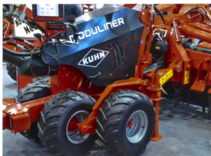
Neben zwei grossvolumigen Niederdruckreifen tragen neu zusätzlich vier vorlaufende Räder das Maschinengewicht.
