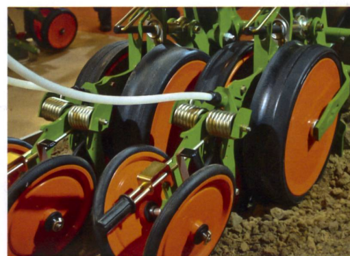
Namhafte Hersteller von Sätechnik fördern heute bei der Einzelkornsäat das Saatgut mit Druckluft.
