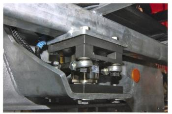
Wiegetechnik mit Dehn- und Drucksensoren von Fliegl: Bisherige Sensoren mit Verteilerbox werden ersetzt durch spezielle digitale auf elektronischer Basis arbeitende Wägezellen mit direktem Can-Bus-Ausgang zur Erfassung, Dokumentation und Rückverfolgbarkeit am Isobus-Terminal.
