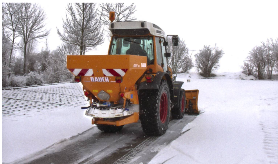
Erstmals präsentiert Rauch bei einem Winterdienststreuer, dem Axéo 6.1, eine fernbediente Streubreitenverstellung mit intelligenter Mengenanpassung, sei es bei Sand, Salz, Splitt oder Dünger. Die intelligente Elektronik berücksichtigt sogar eine getrennte Verstellung von linker und rechter Seite.
