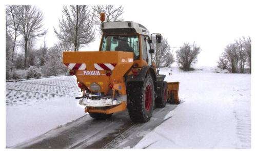
Erstmals präsentiert Rauch bei einem Winterdienststreuer, dem Axeo 6.1, eine fernbediente Streubreitenverstellung mit intelligenter Mengenanpassung, sei es bei Sand, Salz, Splitt oder Dünger. Die intelligente Elektronik berücksichtigt sogar eine getrennte Verstellung von linker und rechter Seite.
