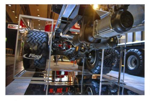
Triebachse «Power DriveElect», eine Zusammenarbeit mit John Deere. Das System nutzt die Energieeffizienz von integrierten Stromgeneratoren künftiger Traktorengenerationen. Dank der angetriebenen Achse stellt man sich vor, dass das Zugfahrzeug leistungsmässig zwar up-todate sein muss, gewichtsmässig aber eine leichtere Konstruktion möglich ist als heute.
