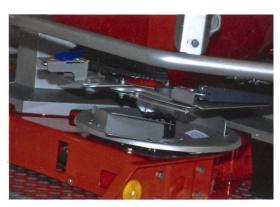
Die Steuerung Spread Control von Rauch für Scheibendüngerstreuer bietet die Möglichkeit, das Öffnen und Schliessen der Dosierschieber an Vorgewenden und Streukeilen zu automatisieren; dies unter Berücksichtigung der Stoffeigenschaften des Mineraldüngers.
