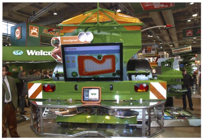
AcuraSpread von Amazone ist eine intelligente Software für das Restmengenmanagement; es gleicht die zu behandelnde Fläche mit der verbleibenden Behälterfüllung ab. (Bilder: Dominik Senn)
