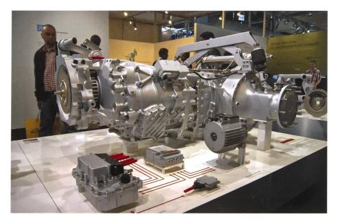
ZF entwickelte das Generatormodul ZF-Terra+ nach dem Baukastenprinzip als integrierten Bestandteil des Triebwerks oder als separates Zapfwellenmodul inklusive Leistungselektronik und Energiemanagement. Die neue Lenkachse ZF-Terrasteer komplettiert den Antriebsstrang zu einem perfekt abgestimmten Gesamtsystem.
