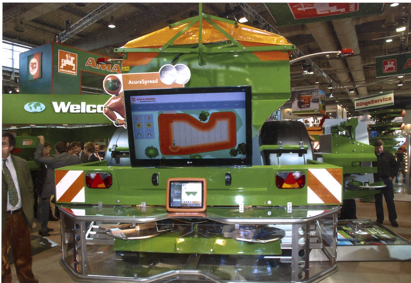
AcuraSpread von Amazone ist eine intelligente Software für das Restmengenmanagement; es gleicht die zu behandelnde Fläche mit der verbleibenden Behälterfüllung ab. (Bilder: Dominik Senn)
