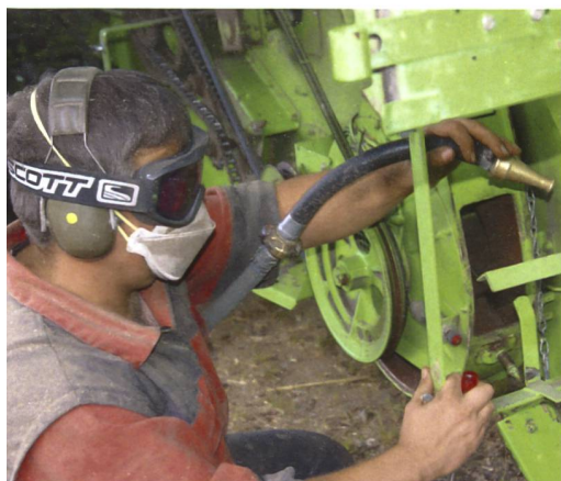
Ohne Staubmaske und geschlossene Schutzbrille wäre das Ausblasen für Dominique Berner äusserst unangenehm.
