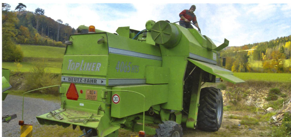
Mähdrescherreinigung mit Luft statt mit Wasser; die Maschine dankt es mit einer langen Lebensdauer.
