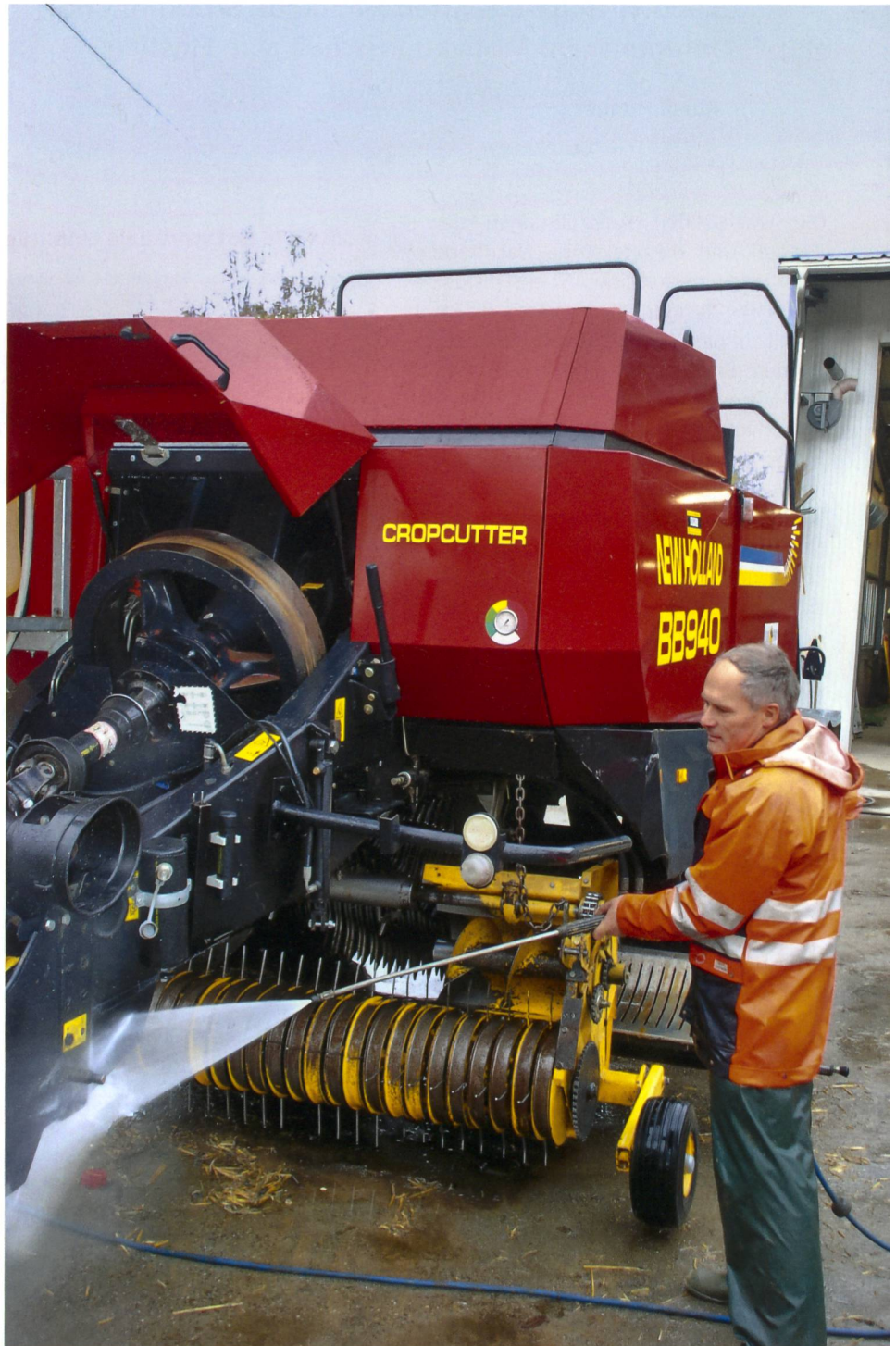
Ruedi Emch reinigt mit dem Hochdruck-Wasserstrahl so, dass verborgene Schäden bei der genauen Durchsicht erkennbar werden. (Bilder: Hansueli Schmid, Dominik Senn)
