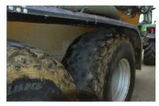
Reifen sind auf Beschädigungen, vor allem an den Aussen- und Innenflanken, sowie auf Luftdruck zu kontrollieren.
