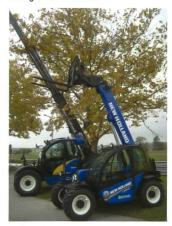
Die Standsicherheit ist bei Teleskopladern sehr wichtig. Die Lader mit der 4-Rad-Lenkung haben grosse Vorteile gegenüber den knickgelenkten Ma-schinen. Der LM 5020 hat mit 3,40 m einen optimalen Wenderadius (4 m beim LM 5030).
