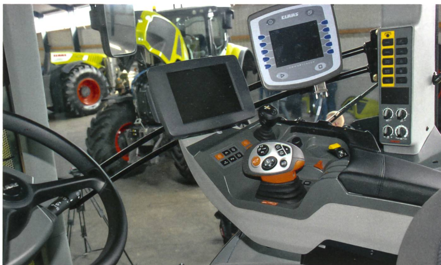
Das Cockpit mit Lenkrad, mit dem A-Bedienpanel (Cmotion und Cebis-Terminal) und dem B-Bedienpanel (Isobus-Gerätebedienung und GPS-Lenkung).
