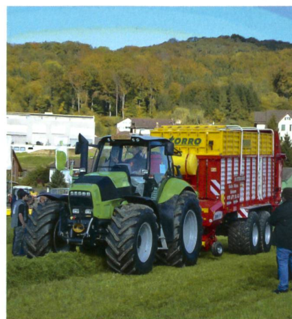
Beim Torro können die 39 Messer automatisch in wenigen Minuten geschliffen werden.
