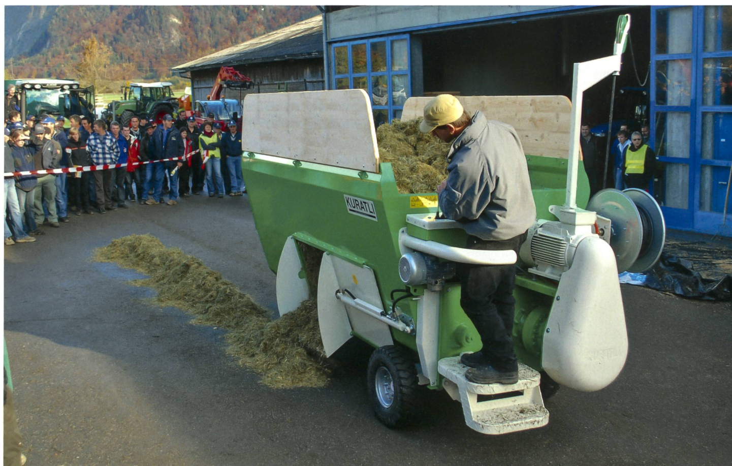
Der elektrisch angetriebene Wagen von Kuratli ist bereits ein Vertreter der Futtermischwagen. Foto: Christoph Jenni
