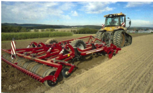
Der Terrano 4 MT eignet sich vor allem zur Bearbeitung schwerer Böden. Diese werden tief gelockert, dabei werden die Ernterückstände aber nur flach eingemischt.
