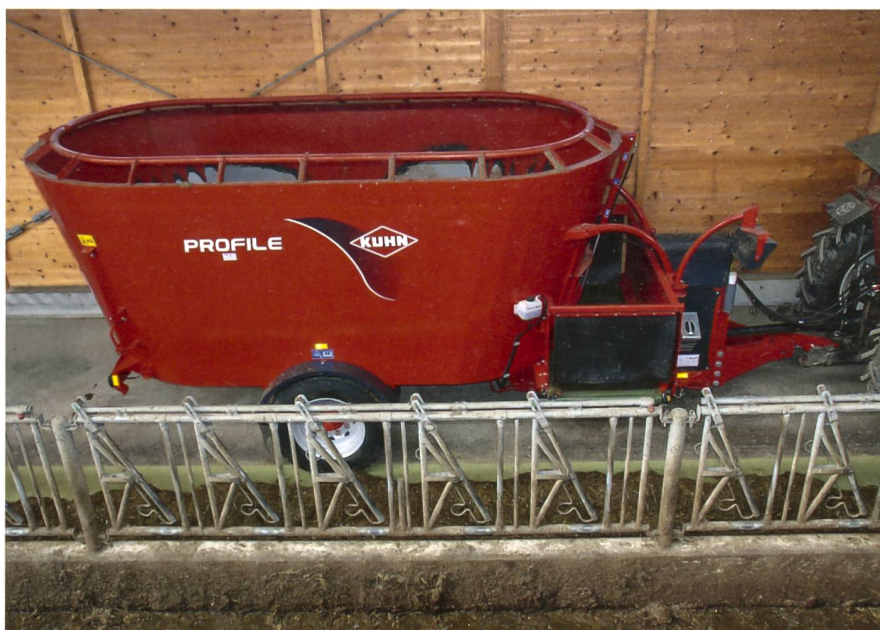
Die Futtermischwagengeneration Kuhn-Profile zeichnet sich insbesondere bei engen Verhältnissen aus und ist speziell für Betriebe mit wenig Platz entwickelt worden. Durch die Anordnung der Räder an der Aussenseite des Behälters hat die 14-m 3 -Maschine mit der Bereifung 295/60 eine Höhe von nur 2,46 m und eine Aussenbreite von 2,31 m. Mit dem vorne angebrachten Verteilband kann das Futter sowohl nach links als auch nach rechts verteilt werden. (Bilder: Dominik Senn)
