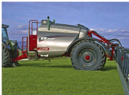
Die Leeb GS 8000 ist die dritte Feldspritze im Horsch- Pflanzenschutzprogramm, als gezogene 8000-l-Spritze eine Weiterentwicklung der kleineren Leeb GS 6000.
