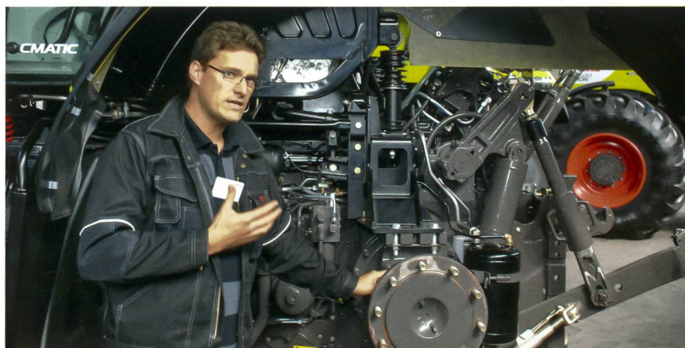
Ansgar Koenen erklärt Bau und Funktionsweise der Hinterachse; in der Bildmitte eines der vier Federelemente der Kabine.
