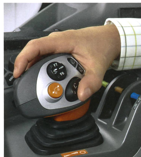
Das Dreifingerkonzept ermöglicht die intuitive Steuerung von bis zu 20 Funktionen, ohne umgreifen zu müssen. (Werkbild)
