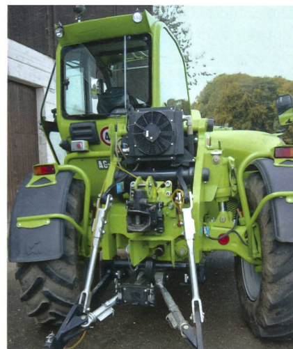
Der Multifarmer weist eine garantierte Anhängelast von 21 Tonnen auf. Die Dreipunkthydraulik, fest verbunden mit dem Chassis, bewegt sich beim Ausgleich eines Quergefälles über die Hydraulikzylinder mit.
