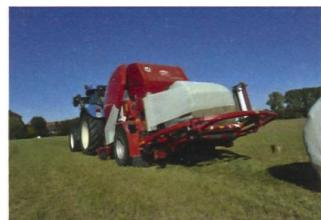
Die Maschine hat eine Gesamtbreite von 2,70 m. Mit dem Ringwickler in der vertikalen Transportposition kann der Bediener leicht schmale Straßen und Feldzufahrten bewältigen. Die gut positionierte Einzelachse gewährleistet eine hervorragende Manövriereichweite im Feld und auf der Straße.
