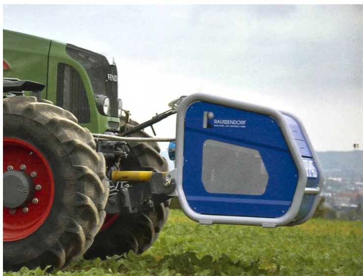
Der PowerPack 45 von der Firma Raussendorf liefert bis zu 45 kW elektrische Leistung für Anbaugeräte, ohne dass Umbauten am Traktor vorgenommen werden müssen. Foto: EAAT Chemnitz
