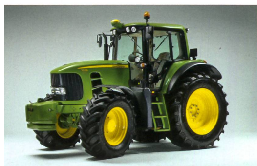
Die E-Premium-Traktoren von John Deere gehören zu den ersten Serienmodellen mit einem integrierten System zur Erzeugung und Verteilung hoher elektrischer Leistung. Foto: John Deere
