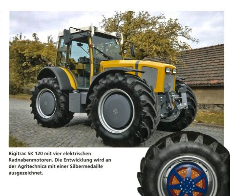
statteten Bergtraktors bringe der Radnabenantrieb einen echten Mehrwert», heisst es in einer Verlautbarung der TU Dresden. Durch die exakte Regelbarkeit der Elektromotoren sei permanent eine genaue Traktionskontrolle jedes einzelnen Rades möglich. So werde Schlupf vermieden und Kraftstoff gespart.
