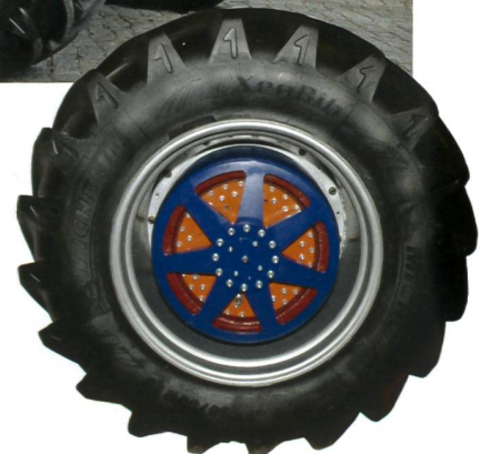
Der an der TU Dresden entwickelte elektrische Radnabenantrieb. Der orangefarbene Teil ist der fest auf der Achse sitzende Stator mit Planetengetriebe, um den sich der Rotor (blau) mit dem Rad dreht. Foto: Carmen Rudolph
