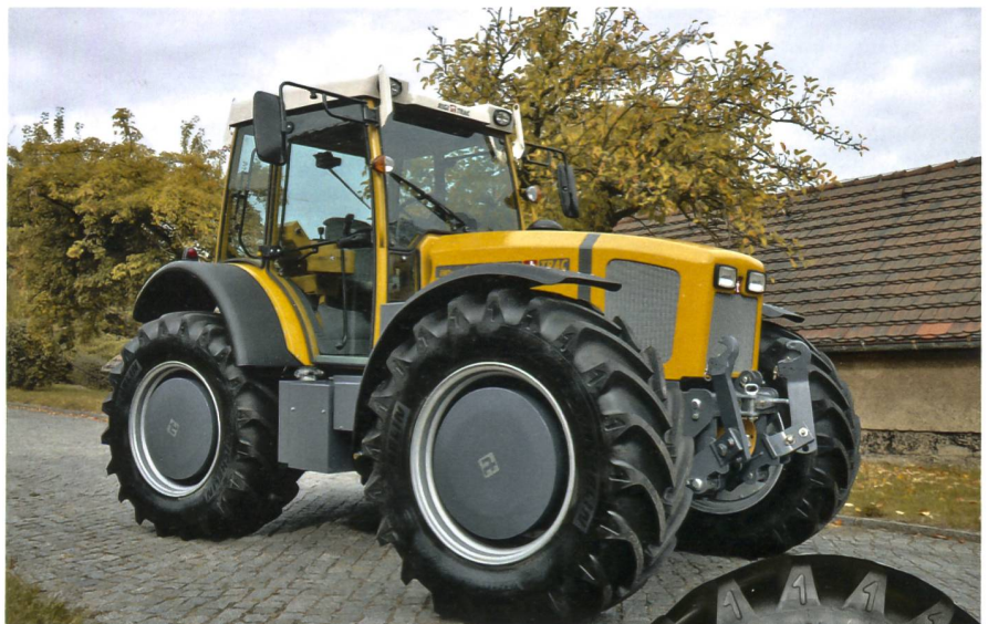
Rigitrac SK 120 mit vier elektrischen Radnabenmotoren. Die Entwicklung wird an der Agritechnica mit einer Silbermedaille ausgezeichnet.
