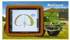
Windeinflusses beim Einsatz von Zentrifugalstreuern entwickelt worden. Der Streuer ist mit einer Wetterstation ausgerüstet, die die momentan wirkenden Windverhältnisse in Stärke und Richtung im Bereich des Streufächers erfasst. Die Stoffeigenschaften des Düngers wirken sich auf die Schwebegeschwindigkeit aus. Mit der messtechnisch ermittelten Schwebegeschwindigkeit lässt sich wiederum der Luftwiderstandsbeiwert be-
