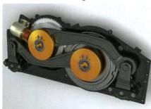
Übliche Messerantriebe bei Schneidwerken sind entweder einseitig oder bei grossen Arbeitsbreiten von mehr als zehn bis elf Metern beidseitig angebracht. Beidseitige Antriebe müssen synchronisiert werden, um Vibrationen der sonst nicht exakt gegenläufigen Messer zu minimieren. Darüber hinaus wird das
