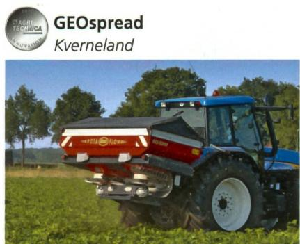
Mit GEOspread ausgerüstete Zentrifugalstreuer helfen dem Nutzer, Dünger am Feldrand, am Vorgewende und in Keilen
