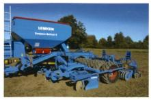
Antischlupfregelung: Insbesondere auf sandigen Böden kann es auch bei Packerwalzen mit grossem Durchmesser zum Aufschieben von Boden kommen. Durch das Impulsrad der Bestellkombination wird die tatsächliche Fahrgeschwindigkeit gemessen und mit der Drehzahl der Packerwalze verglichen. Beim Aufstauen von Erde entsteht Schlupf an der Walze. Durch die Einbindung des Bodenwalzen-
