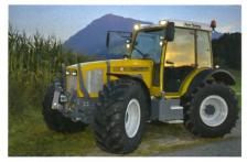
Die elektrischen Einzelradmotoren lassen sich individuell sehr präzise steuern, wodurch erstmalig gezielt Drehmomente aufgebaut werden können (Torque Vectoring). Dies bietet in Hanglagen Vorteile bezüglich der Fahrsicherheit und ist in der Ebene die Voraussetzung für eine Optimierung der Traktion. An externe Verbraucher kann bis zu 80 kW elektrische Leistung abgegeben werden.
