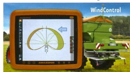
Windeinflusses beim Einsatz von Zentrifugalstreuer entwickelt worden. Der Streuer ist mit einer Wetterstation ausgerüstet, die die momentan wirkenden Windverhältnisse in Stärke und Richtung im Bereich des Streufächers erfasst. Die Stoffeigenschaften des Düngers wirken sich auf die Schwebegeschwindigkeit aus. Mit der messtechnisch ermittelten Schwebegeschwindigkeit lässt sich wiederum der Luftwiderstandsbeiwert be-
