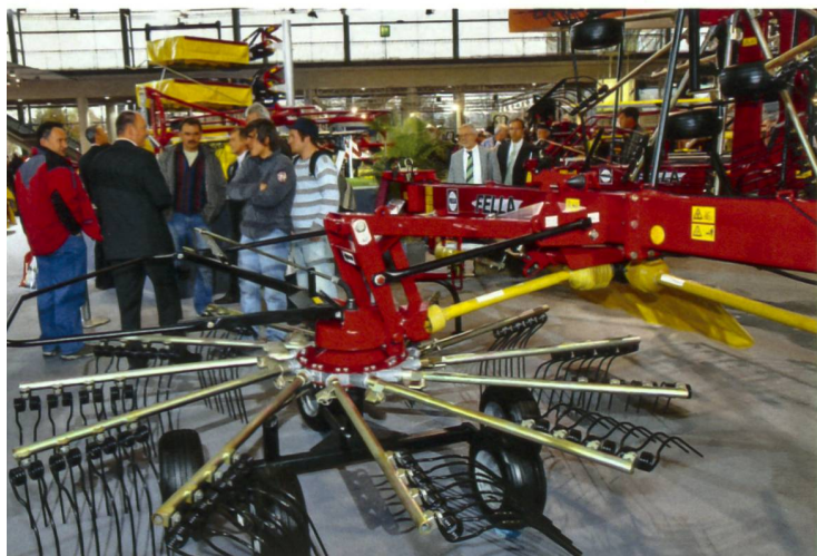
Die Technik der Teilbreitenschaltung findet neu auch beim Mehrkreiselchwader Anwendung.
