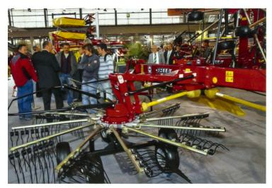
Die Technik der Teilbreitenschaltung findet neu auch beim Mehrkreiselschwader Anwendung.
