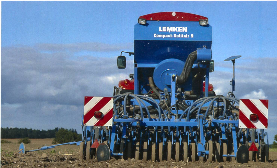
Die pneumatische Bestellkombination Compact-Solitaire 9 mit 4 Metern Arbeitsbreite verfügt über einen 3500-Liter-Saatguttank.
