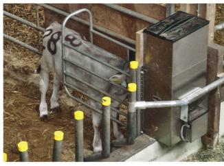
Abb. 6: Am Kraftfutterautomaten kann die Futteraufnahme genau erfasst und die noch benötigte Milchmenge für eine täglich bedarfsgerechte Energieversorgung errechnet werden.
