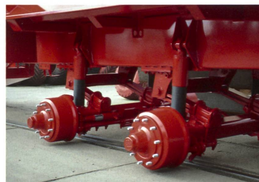
Fahrwerke mit hydropneumatischer Federung.
