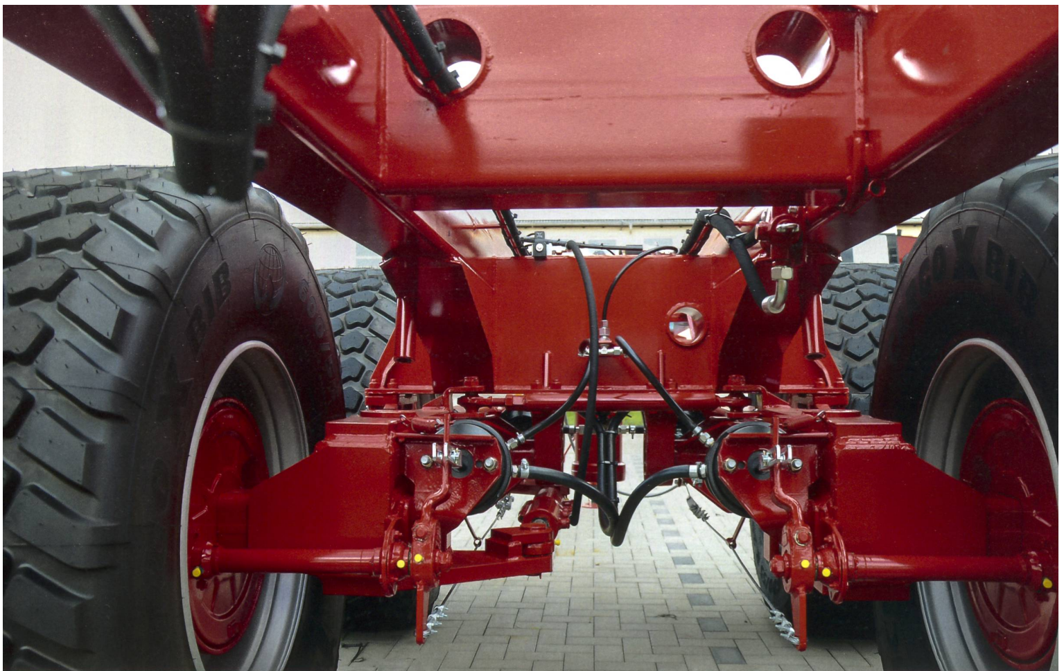
Pendelfahrwerk mit Lenkachse und pneumatischer Bremse.
