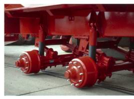
Fahrwerke mit hydropneumatischer Federung.
