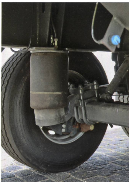
Luftfederung kommt auch für grosse Transportanhänger in der Landwirtschaft infrage.
