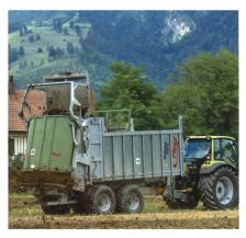
Die verzinkte Mulde des mit zwei stehenden Streuwalzen ausgerüsteten Mistzetters mit Schiebetechnik fasst zwischen neun und vierzehn Kubikmeter.
