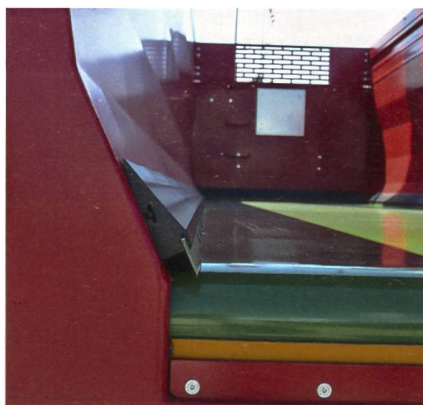
Eine reissfeste, gummierte Gewebematte fördert das Ladegut nach hinten.
