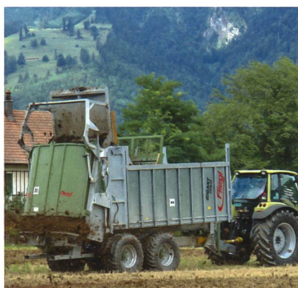
Die verzinkte Mulde des mit zwei stehenden Streuwalzen ausgerüsteten Mistzettlers mit Schiebetechnik fasst zwischen neun und vierzehn Kubikmeter.
