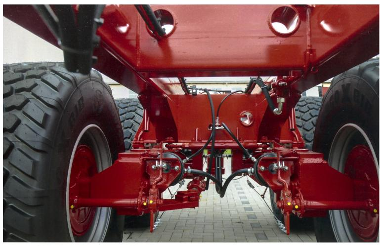
Pendelfahrwerk mit Lenkachse und pneumatischer Bremse.
