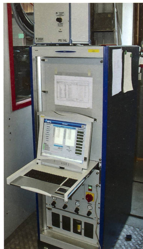
Komplexes Messgerät zur Bestimmung der Abgasemissionen.
