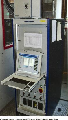
Komplexes Messgerät zur Bestimmung der Abgasemissionen.
