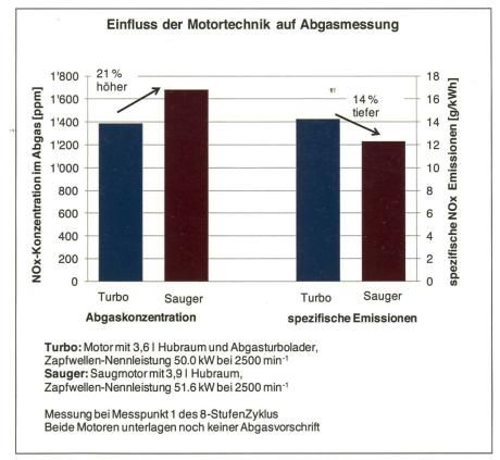
Für eine aussagekräftige Abgasmessung ist die alleinige Messung der Schadstoffkonzentration im Abgas nicht ausreichend. Der Turbomotor hat zwar eine geringere Schadstoffkonzentration im Abgas, die Abgasmenge ist aber aufgrund der Verdichtung durch den Turbolader deutlich höher, sodass die spezifischen Emissionen beim Turbomotor höher ausfallen.
