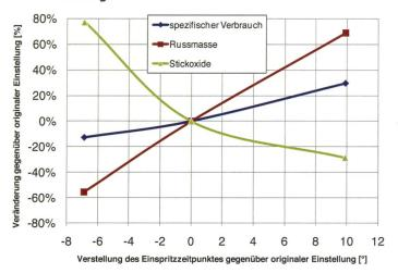
Auswirkungen unterschiedlicher Einspritzzeitpunkte auf Abgasemissionen (Russmasse und Stickoxide) und den spezifischen Verbrauch, gemessen an einem Motor der Abgasstufe II mit mechanischer Einspritzpumpe; 0° entspricht der werkseitigen Originaleinstellung. (Abbildungen: ART, Marco Landis)
