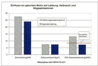
Nur durch eine exakte Abgasmessung konnte der getunte Motor anlässlich eines Traktorentests erkannt werden, da die verbrauchte Menge an Diesel nicht verändert wurde.
