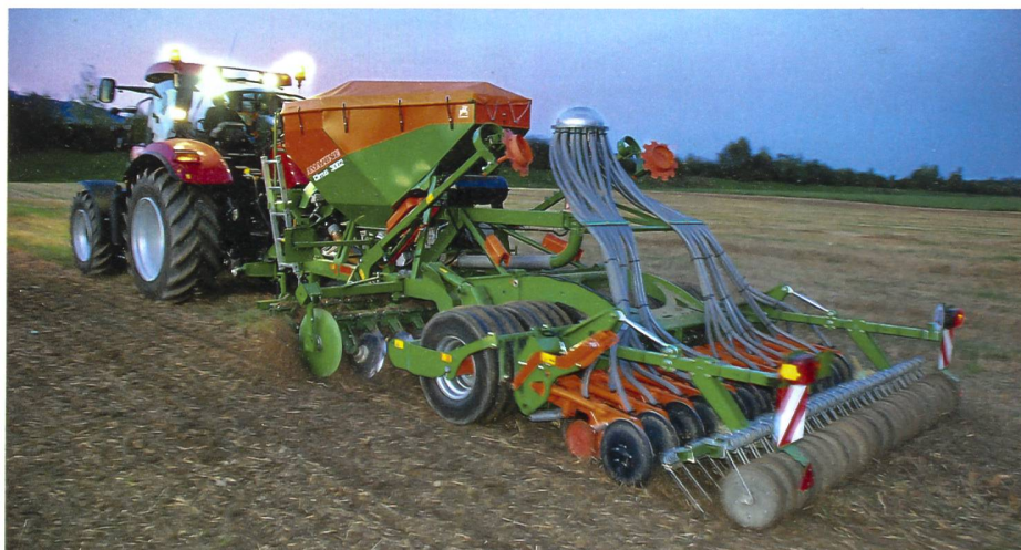
Die Cirrus-3002-Sämaschine von Amazone mit Tank/Dosierer, Kompaktscheibenegge für die Saabettbereitung, Keilringreifen für die Rückverfestigung, die Saatablage und die Saateinbettung mittels Exaktstriegeel und Rollenbalken im nächtlichen Einsatz. Bilder: Dominik Senn
