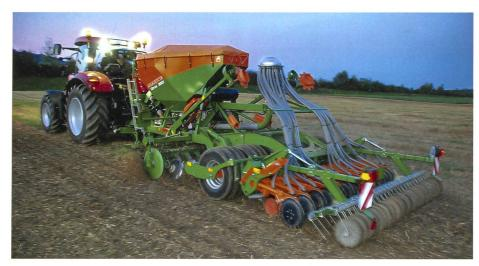
Die Cirrus-3002-Sämaschine von Amazone mit Tank/Dosierer, Kompaktscheibenegge für die Saatbettbereitung, Keilringreifen für die Rückverfestigung, die Saatablage und die Saateinbettung mittels Exaktstriegel und Rollenbalken im nächtlichen Einsatz. Bilder: Dominik Senn
