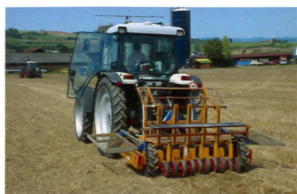
Hochpräzises und ultralangsame Fahren mit dem Setzgerät am Hürlimann dank Trimble-Autopilot.
