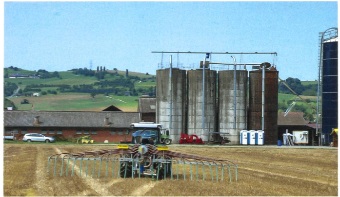
Teilbreitenschaltung am Fankhauser-Schleppschlauchverteiler vor der imposanten Hofkulisse von Viktor Schwaller.
