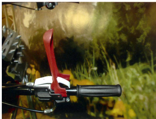
Beim Loslassen des neuen Totmanngriffs stellt der Motor bei Motoreinachsern, Bodenfräsen und -hacken nicht mehr ab. Nur der Arbeitsgeräteantrieb wird unterbrochen.
