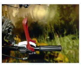
Beim Loslassen des neuen Totmanngriffs stellt der Motor bei Motoreinachsern, Bodenfräsen und -hacken nicht mehr ab. Nur der Arbeitsgeräteantrieb wird unterbrochen.
