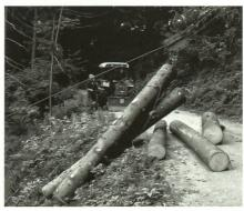
MAXWALD Kleinseilbahnsystem/komplettes Set mit 3-Punkt-Traktor, Seilwinde Typ 300XL (Option Mobile-Motor-Winde), kopfhoch, bergauf, Arbeitslänge 250 m.
