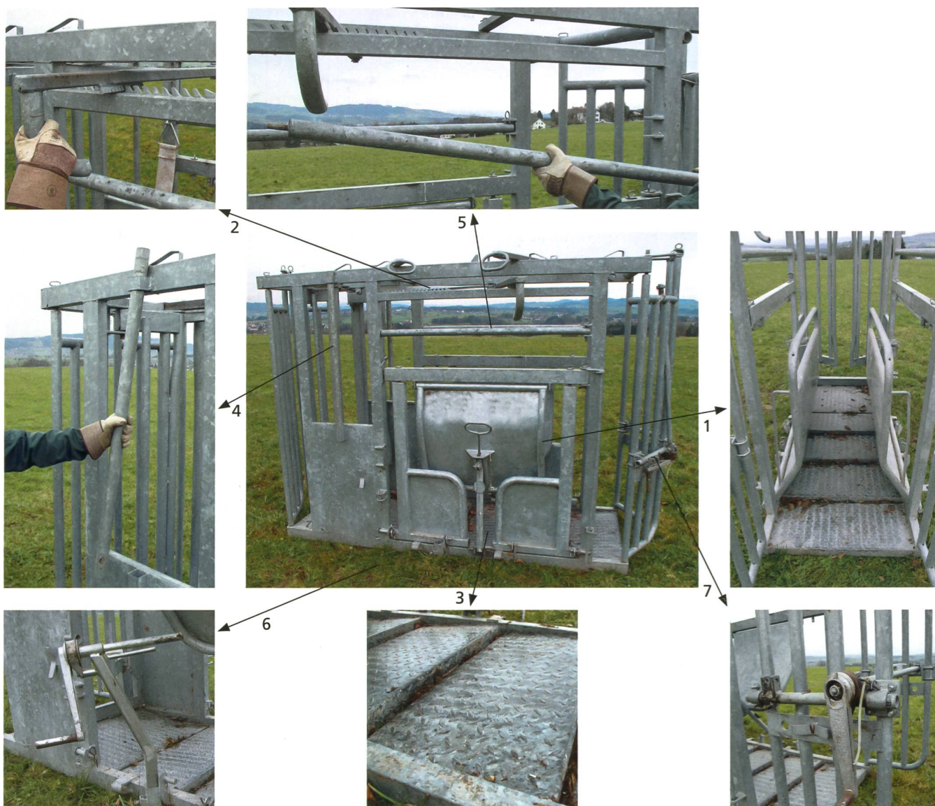
Abb. 10: Bei einem Behandlungsstand sollten die Breite des Standes eingestellt und die Tiere seitlich fixiert werden können sowie ein sicherer Zugang zu den Tieren gewährleistet sein: Verengungsbleche für Jungtiere (1), Arretierung für die Fixierung der Tiere (2), rutschfester Boden (3), vorderer Zugang zu den Tieren (4), seitlicher Zugang zu den Tieren (5), Fusswinde vorn mit lastunabhängiger Bremse (6), in zwei Positionen verstellbare Fusswinde hinten mit lastunabhängiger Bremse (7).
