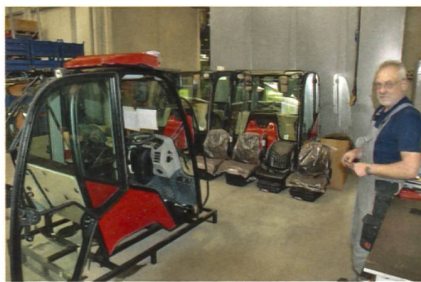
Qualitativ hochwertige Komponenten wie Fahrkabinen und Sitze liegen vormontiert zum Aufbau bereit.
