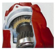
Wartungs- und verschleissfreie Lamellenbremsen (gelb) stellen ein sicherheitsrelevantes Bauteil dar.
