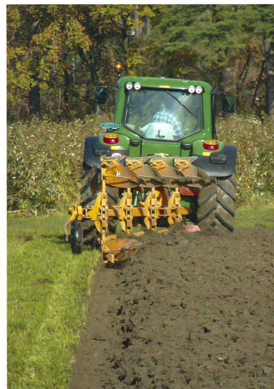
Durch eine reduzierte Arbeitstiefe lässt sich viel Kraftstoff einsparen.
