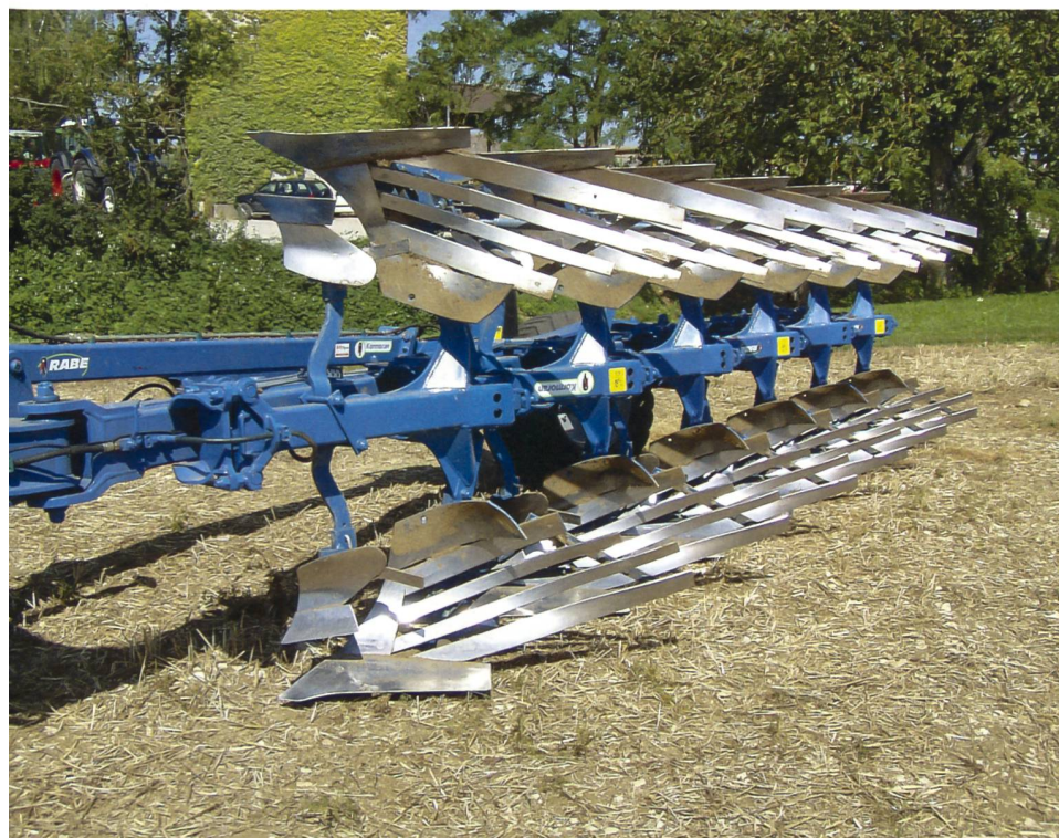
In schwierigen Böden wird die Reibkraft durch die kleinere Kontaktfläche der Streifenriester verringert.
