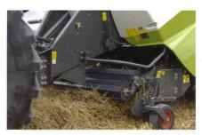
Die neue Claas-Ballenpresse Quadrant 3300 schliesst die Lücke zwischen den Modellen 3200 und 3400. Die Presse ist mit einem neu entwickelten Vorkammersystem ausgerüstet, das automatisch und durch den Fahrer gesteuert werden kann. Raffer, Rotor sowie Pick-up sind interaktiv aufeinander abgestimmt.
