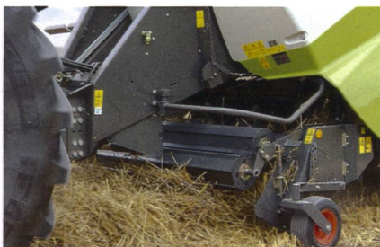
Die neue Claas-Ballenpresse Quadrant 3300 schliesst die Lücke zwischen den Modellen 3200 und 3400. Die Presse ist mit einem neu entwickelten Vorkammersystem ausgerüstet, das automatisch und durch den Fahrer gesteuert werden kann. Raffer, Rotor sowie Pick-up sind interaktiv aufeinander abgestimmt.
