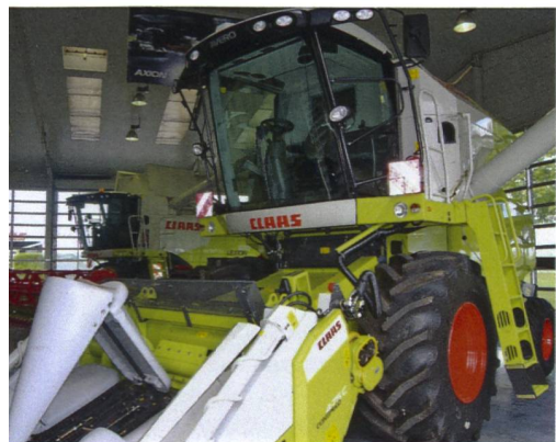
Avero 160 mit Maispflückvorsatz Conspeed. Dieser erlaubt eine rasche Umrüstung von Mais- auf Sonnenblumendrusch.
