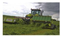
Disco 9100 Autoswather mit Rollenaufbereiter bietet alle Möglichkeiten der Schwadoder Breitablage, aufgenommen in einem prächtigen Luzernebestand. Erhebliche Bröckelverluste trübten allerdings das Bild.
