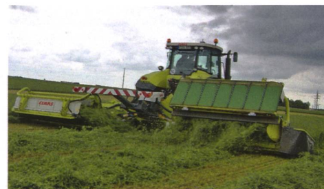
Disco 9100 Autoswather mit Rollenaufbereiter bietet alle Möglichkeiten der Schwad- oder Breitablage, aufgenommen in einem prächtigen Luzernebestand. Erhebliche Bröckelverluste trübten allerdings das Bild.
