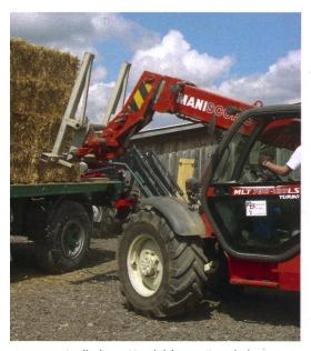
In direktem Vergleich zum Frontlader erreichen Teleskoplader schnellere Ladezyklen und erzielen grössere Höhen.
