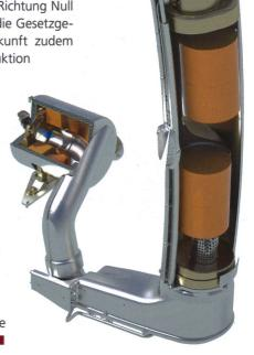
SCR-Bild von MF: SCR-System der zweiten Generation von AGCO Sisu Power, wie es in den Baureihen 7600 und 8600 von Massey Ferguson eingebaut wird: Kombination eines Dieseloxidationskatalysators mit zwei parallel arbeitenden, aber hintereinander angeordneten SCR-Katalysatoren. In letzteren sind Slip-Katalysatoren integriert, welche die Restmengen des Zwischenproduktes Ammoniak auch noch in Luftstickstoff umwandeln.
