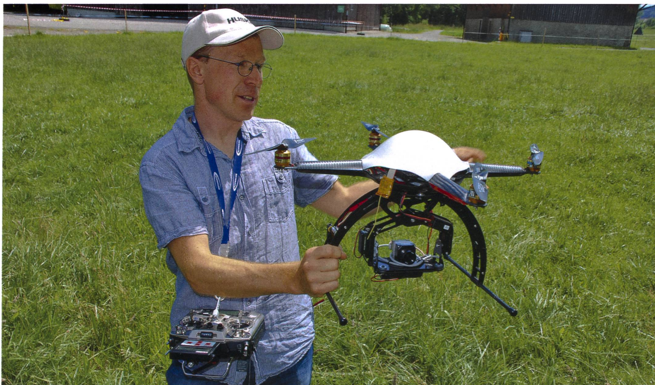
Walter Berger führt an den Agrartechniktage Tänikon seinen Quadrokopter zur Rehkitzerkennung in Wiesen vor. (Bilder: Dominik Senn)
