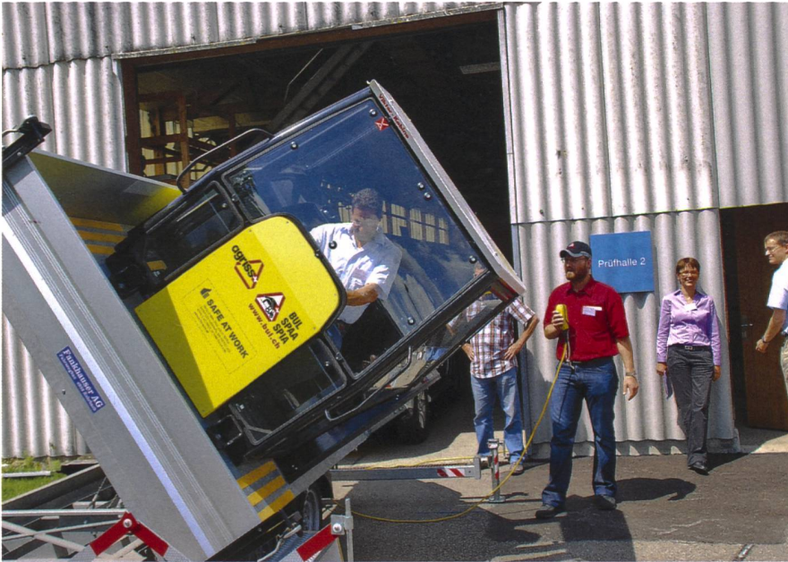
Natanael Burgherr kippt die Sturzkabine bis 60 Grad; der «Fahrer» ist zum Glück angegurtet.
