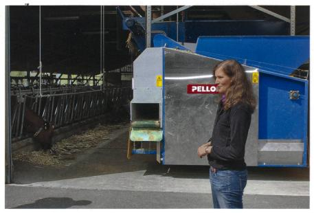
«Der Roboter ist das Gehirn der Anlage», erklärt Versuchsleiterin Anne Grothmann. Er steuert gemäss Eingabe, wie viel Grundfutter von jedem Behälter in den Mischbehälter kommt und wie die Ration entlang des Futtertisches verteilt wird.
