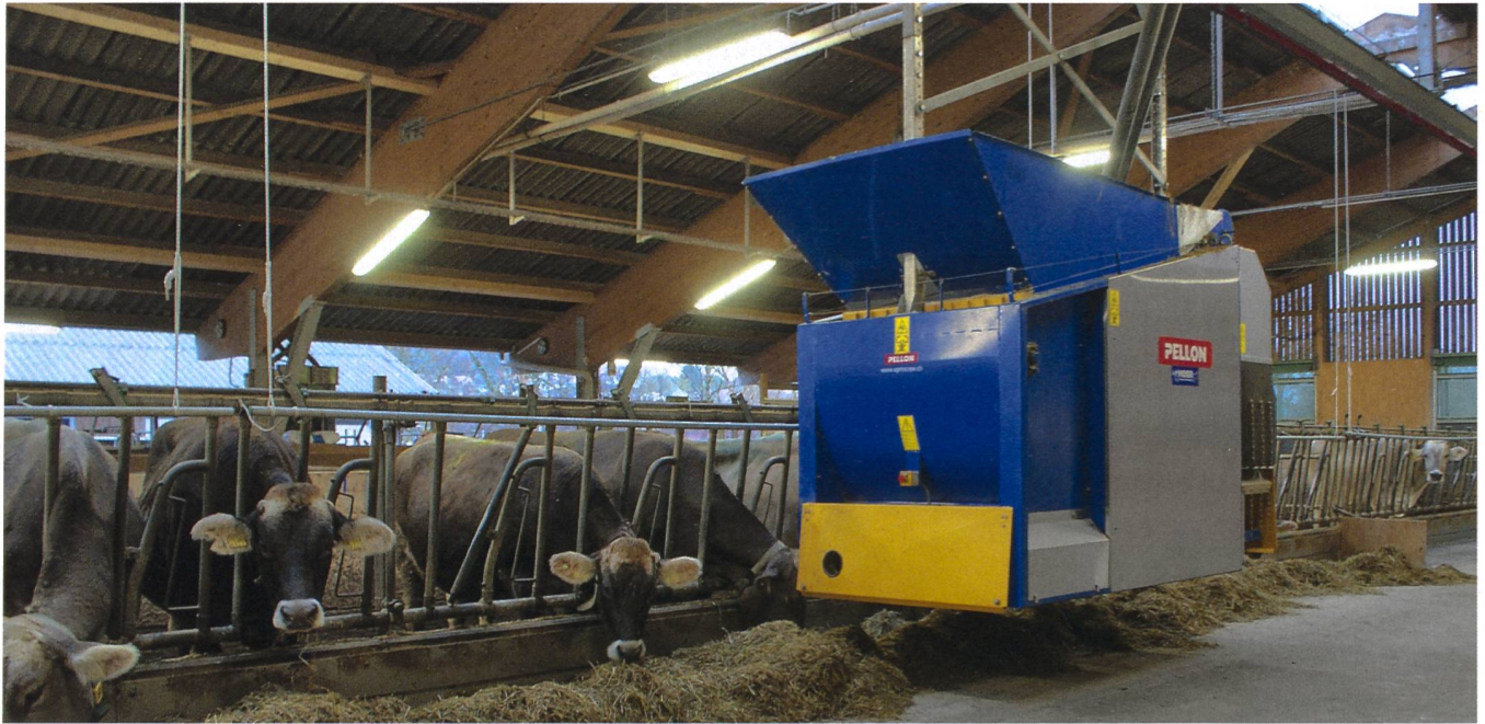
Der an einer Schiene aufgehängte Roboter füttert die Kühe. Er orientiert sich an Magneten, die an der Schiene angebracht sind.
