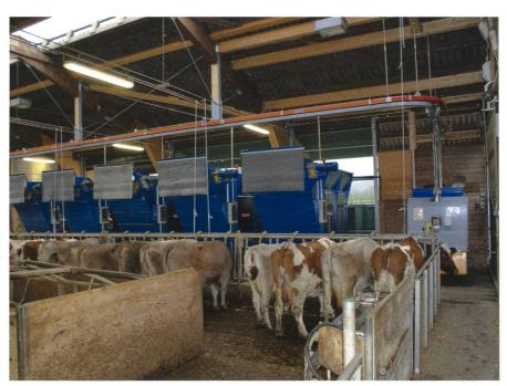
An fünf Vorratsbehältern holt der Roboter (ganz rechts) das Grundfutter und mischt es dann.
