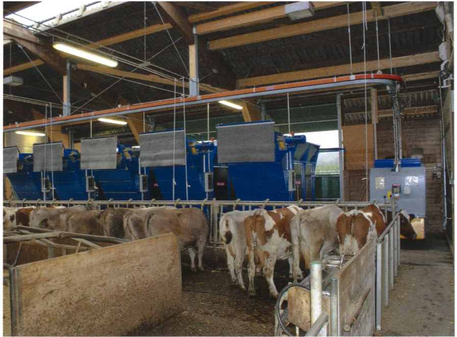
An fünf Vorratsbehältern holt der Roboter (ganz rechts) das Grundfutter und mischt es dann.
