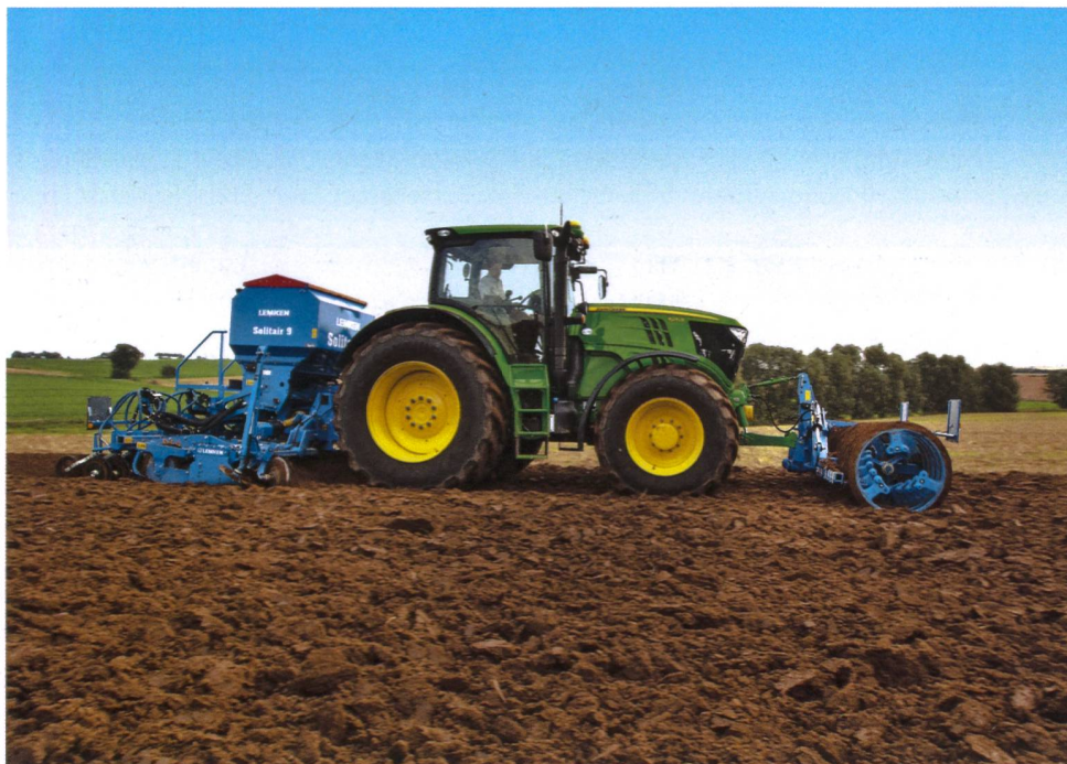
Der John-Deere-Traktor der Serie 6R, hier das Spitzenmodell 6210R mit der pneumatischen Drillmaschine Solitair 9 im Einsatz, steht für eine erweiterte Leistungsdimension. (Werksbild)
