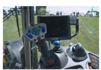
In nur einem Terminal sind verschiedenste Funktion wie Traktorbedienung, ISOBUS-Steuerung, Spurführung und Dokumentation zusammengefasst und nach einheitlichem Konzept bedienbar.
