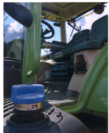
Fahrkomfort wird grossgeschrieben, namentlich auch beim Beifahrersitz, der umgeklappt zudem als Schreibunterlage dient. Im Vordergrund Einfüllstutzen für die Harnstofflösung AdBlue.
