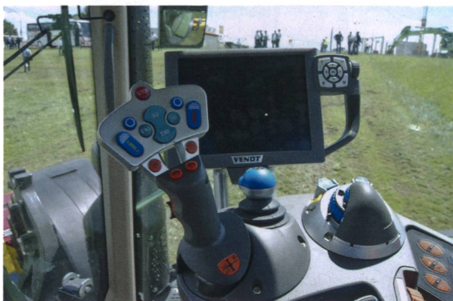
In nur einem Terminal sind verschiedenste Funktionen wie Traktorbedienung, ISOBUS-Steuerung, Spurführung und Dokumentation zusammengefasst und nach einheitlichem Konzept bedienbar.
