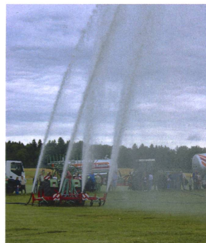
Ein Spektakel der besonderen Art bot der direkte Vergleich der Förderleistung von vier Pumpensystemen (Drehkolbenpumpe/Schneckenpumpe/Gardapumpe und Doda-Flügelradpumpe).
