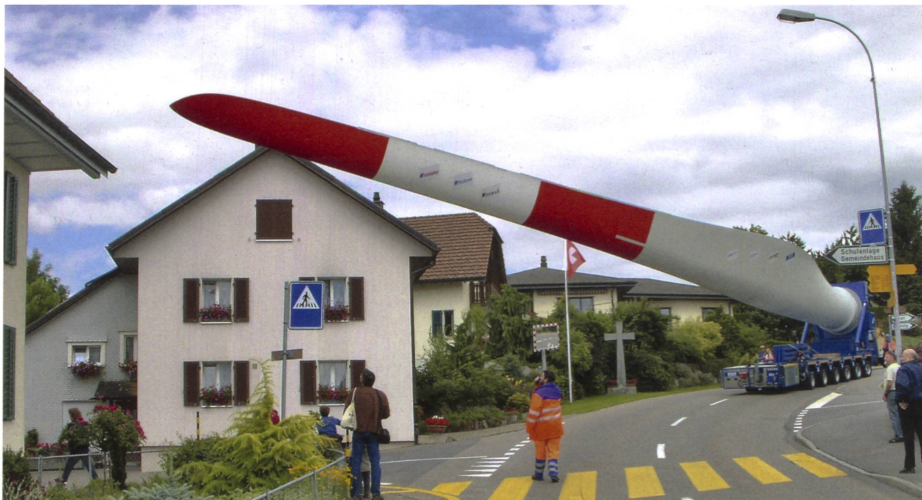
Dank Rotoradapter kann das Rotorblatt durch enge Kurven geschleust werden. (Bild: Pedro Hiller, Wettingen)
