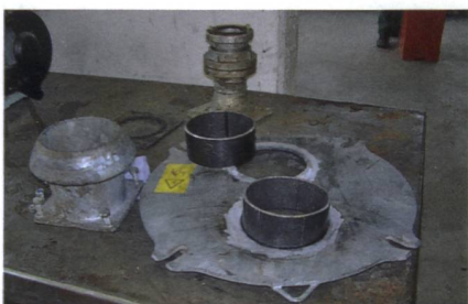
An verzinkten Teilen muss die Zinkschicht im Nahtbereich vollständig weggeschliffen werden.
