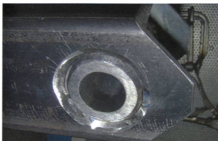
An Stellen, wo die Schweisssnaht nicht vorstehen darf, muss eine entsprechend tiefe Nut geschliffen werden, die einer starken Schweisssnaht Platz bietet.
