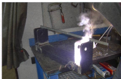
Eine zusätzlich angeschweisste Verstrebung verhindert ein Verziehen der Stahlplatten.
