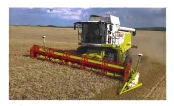
Spannendes Zusatzprogramm bei Claas in Harsewinkel: Z.B: Das MON-TANA- Fahrwerk gleicht Seitenneigungen von bis zu 17% und Längsneigungen von bis zu 6% aus.
