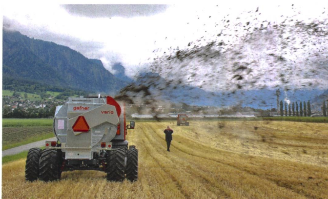
Die Gafner Aufbau-Seitenstreuer haben variable Wurfweiten und erzeugen in Fahrtrichtung eine gute Verteilung.
