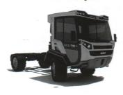
sämtliche Service- und Wartungsarbeiten ist keine Demontage der Anbaugeräte (z.B.: Schneepflug, Schneefräse, Scheibenmäher) mehr erforderlich. Das gesamte Fahrerhaus kann bei Bedarf hydraulisch gekippt werden. Das seitliche Kippen der Kabine erfolgt werkzeuglos und bietet perfekte Zugänglichkeit in den Motor- und Getrieberaum. Durch den innovativen Aufbau der Kippkabine kann die exakte Schaltmechanik des bewährten Reform-Getriebes beibehalten werden.
