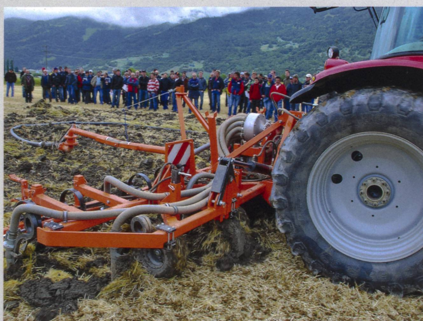
Der Güllegrubber Perwolf mit Schleppschauch und Mengenmessung arbeitet bodenschonend. (Bild: Dominik Senn)
