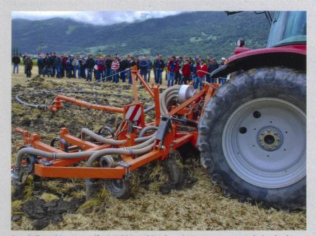
Der Güllegrubber Perwolf mit Schleppschlauch und Mengenmessung arbeitet bodenschonend. (Bild: Dominik Senn)
