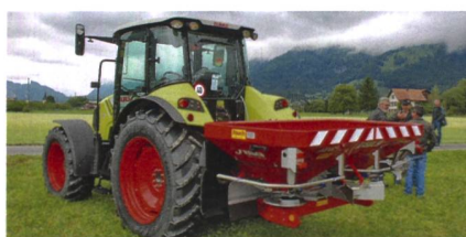
Streutechniken für Handelsdünger vorgestellt, hier ein Rauch-AXIS 20.1 W mit 100-Hz-Wiegetechnik.
