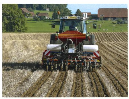
Streifenfrässaat von Raps – optimales Saatbett und optimale Stroheinmischung.
