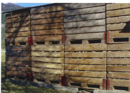
An Luft und Sonne trocknet das vor Regen geschützte Holz innerhalb eines Jahres.
