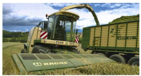
Krone-Big-X-Feldhäcksler Seite an Seite mit dem ZX-Kombiwagen, der als Rotorwagen und auch als Häckseltransporter eingesetzt wird.
