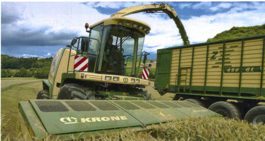
Krone-Big-X-Feldhäcksler Seite an Seite mit dem ZX-Kombiwagen, der als Rotorwagen und auch als Häckseltransporter eingesetzt wird.
