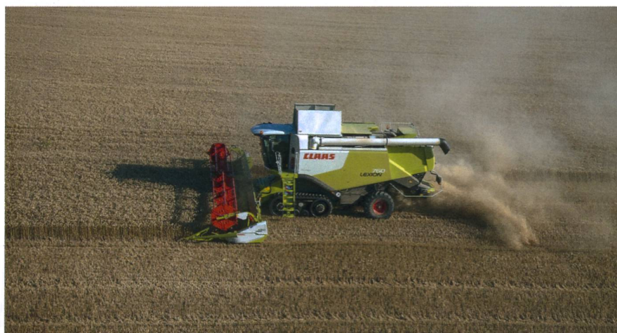
Ziel der neuen Claas-Lexion-IT-Baureihe ist die optimale Auslastung der Druschkapazität. Elektronik und Sensorik erfassen und regeln die leistungsbestimmenden Funktionen.
