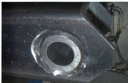
An Stellen, wo die Schweisnaht nicht vorstehen darf, muss eine entsprechend tiefe Nut geschliffen werden, die einer starken Schweisnaht Platz bietet.
