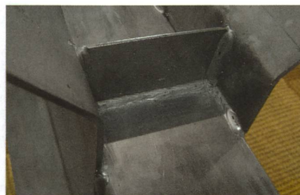
Chromstahl wird mit 20 bis 25% tieferer Stromstärke geschweisst als Baustahl. Die Angaben auf der Verpackung von Chromstahlelektroden sind zu beachten.
