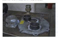
An verzinkten Teilen muss die Zinkschicht im Nahtbereich vollständig weggeschliffen werden.
