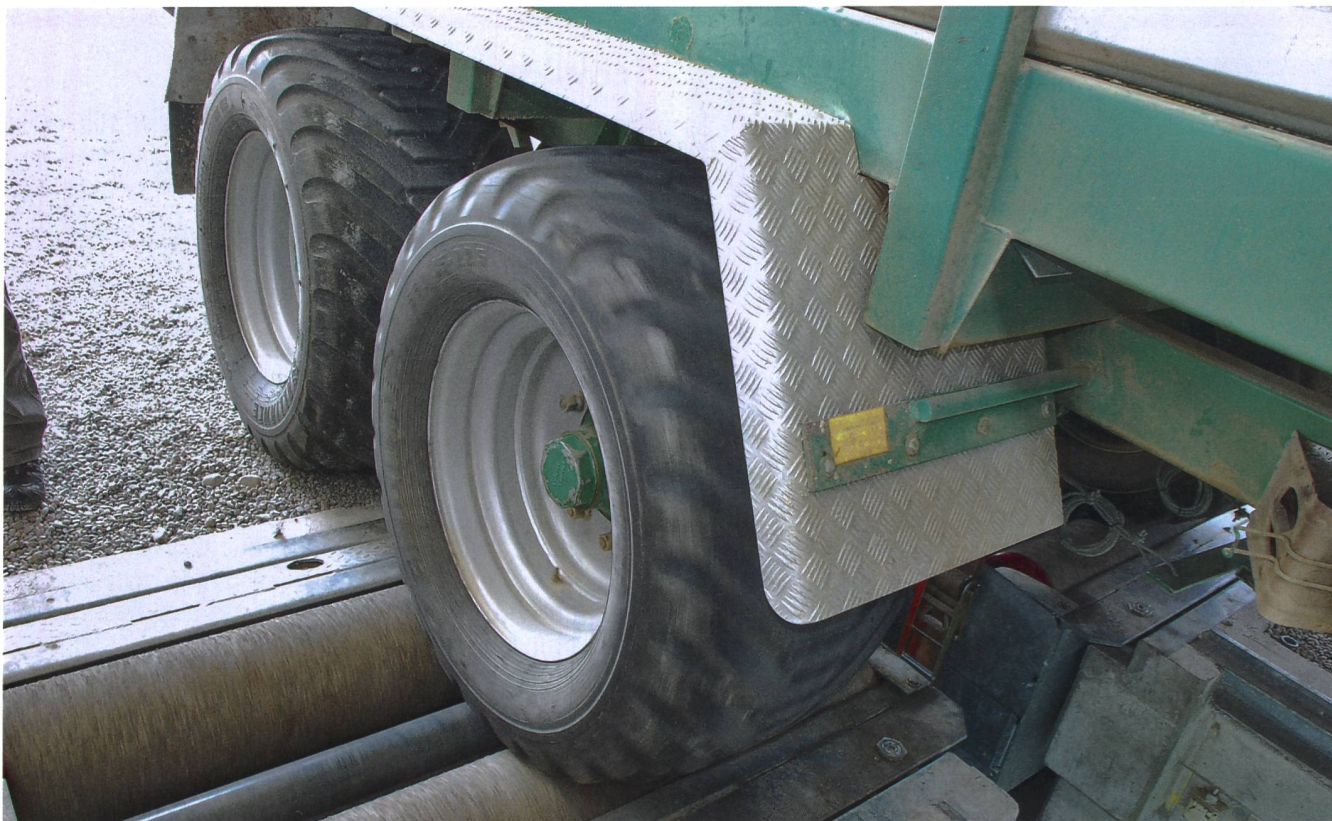
Die Achsen werden auf der automatischen Bremsmessaanlage nacheinander im beladenen Zustand auf ihre Bremsleistung gemessen (zwecks Lastsimulation ist die Achse niedergezurrt). (Bilder: Dominik Senn)
