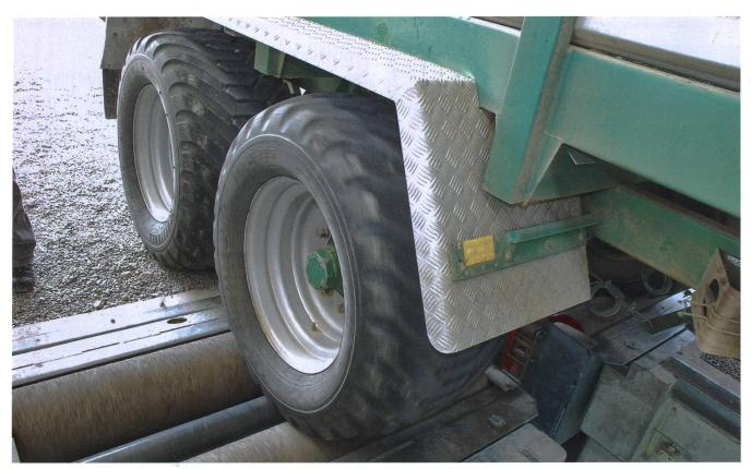
Die Achsen werden auf der automatischen Bremsmessanlage nacheinander im beladenen Zustand auf ihre Bremsleistung gemessen (zwecks Lastsimulation ist die Achse niedergezurrt). (Bilder: Dominik Senn)
