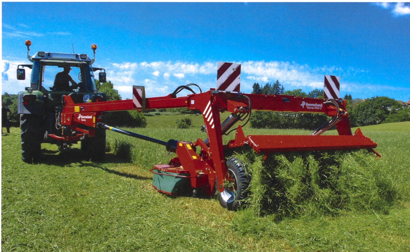
Der Scheiben-Mähknickzetter Kverneland Taarup 4332 LT hat acht Scheiben und eine Arbeitsbreite von 3,20 m. Bei diesem Stahlzinkenaufbereiter können sich die SemiSwing-Zinken nach hinten biegen und lassen Hindernisse bis 103 mm durch, ohne zu brechen.
