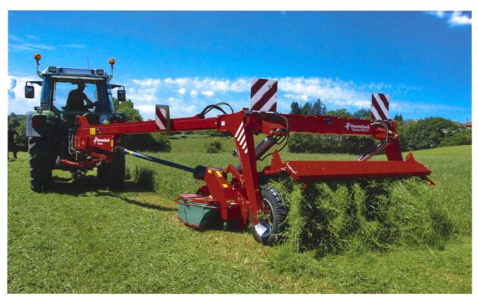
Der Scheiben-Mähknickzetter Kverneland Taarup 4332 LT hat acht Scheiben und eine Arbeitsbreite von 3,20 m. Bei diesem Stahlzinkenaufbereiter können sich die SemiSwing-Zinken nach hinten biegen und lassen Hindernisse bis 103 mm durch, ohne zu brechen.
