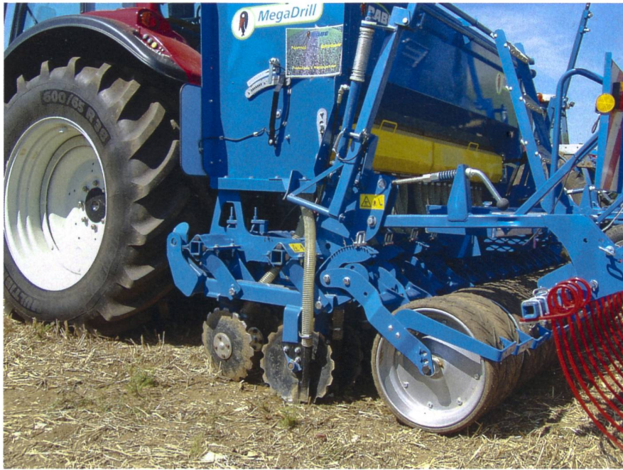
Kurzscheibenegge mit aufgebauter Sämaschine – hier entfällt die klassische Stoppelbearbeitung weitgehend.
