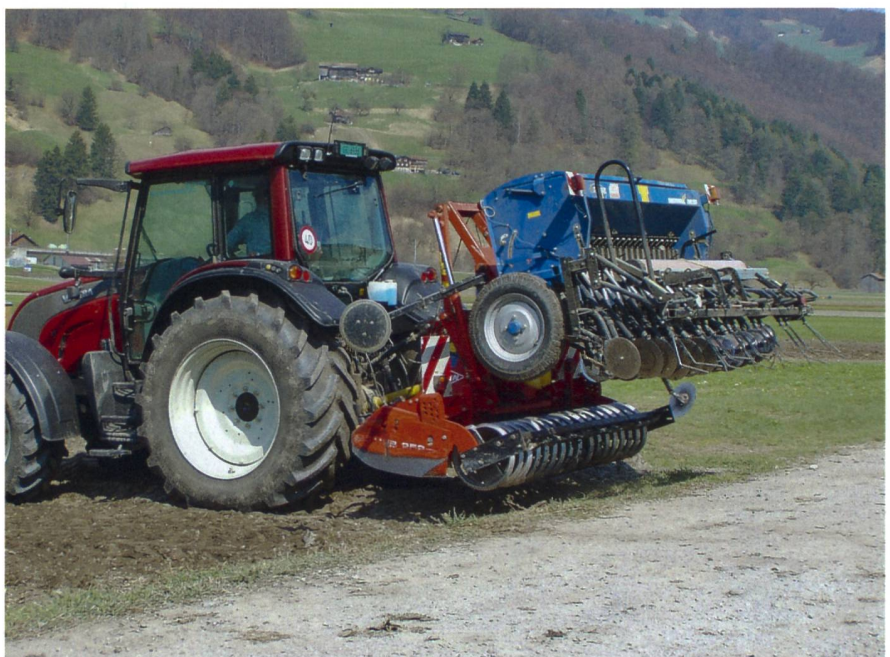
Säkombinationen können nach der Stoppelbearbeitung zur Ansaat einer Folgekultur eingesetzt werden.
